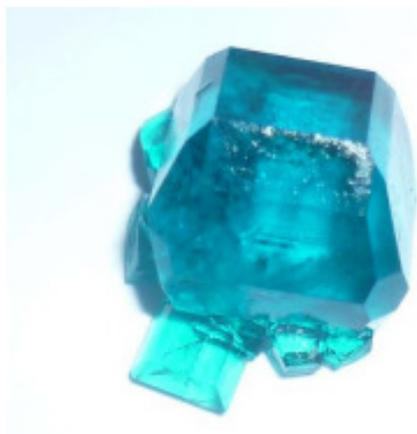
Figura 16: Cristal de Sulfato de Níquel dopado com íons Mn<sup>+2</sup>.
