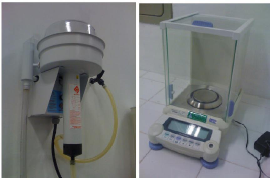
**Figura 12: (12a) Aparelho Destilador; (12b) Balança Analítica.**
