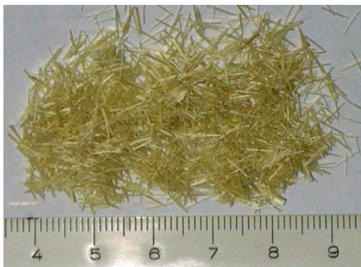
Figura 8: Fibras de sisal cortadas manualmente no comprimento de 5 mm para a fabricação dos compósitos.
