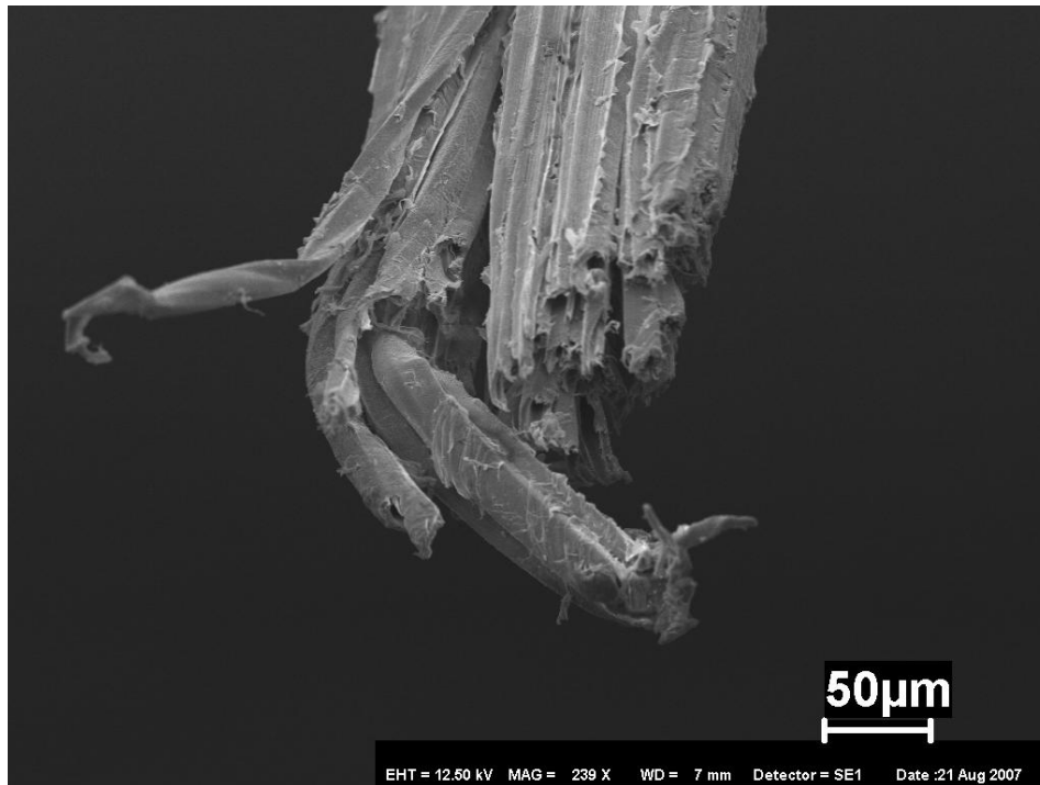
Figura 21: Aspecto da região de fratura da fibra técnica de sisal após ensaio de tração na fibra, ilustrando o rompimento das fibras elementares.
