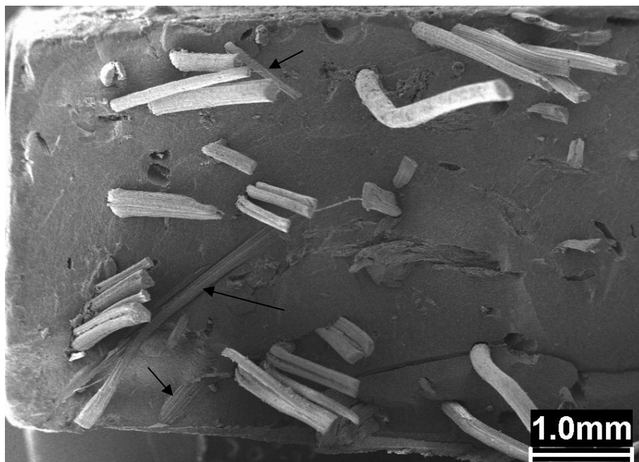
Figura 52: Superfície de fratura de compósitos híbridos reforçados com fibras de sisal 5 mm e pó de maçaranduba. As setas indicam fibras transversais descoladas da superfície de fratura.
