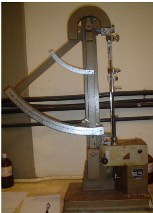
Figura 7: Máquina utilizada para os ensaios de tração nas fibras de sisal.
