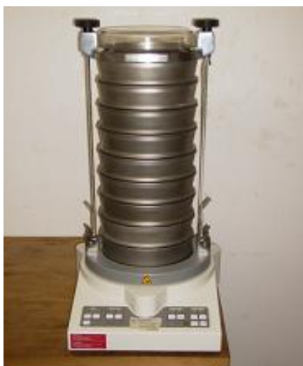
Figura 5: Conjunto de peneiras padronizado utilizado para a caracterização granulométrica dos resíduos de Maçaranduba.
