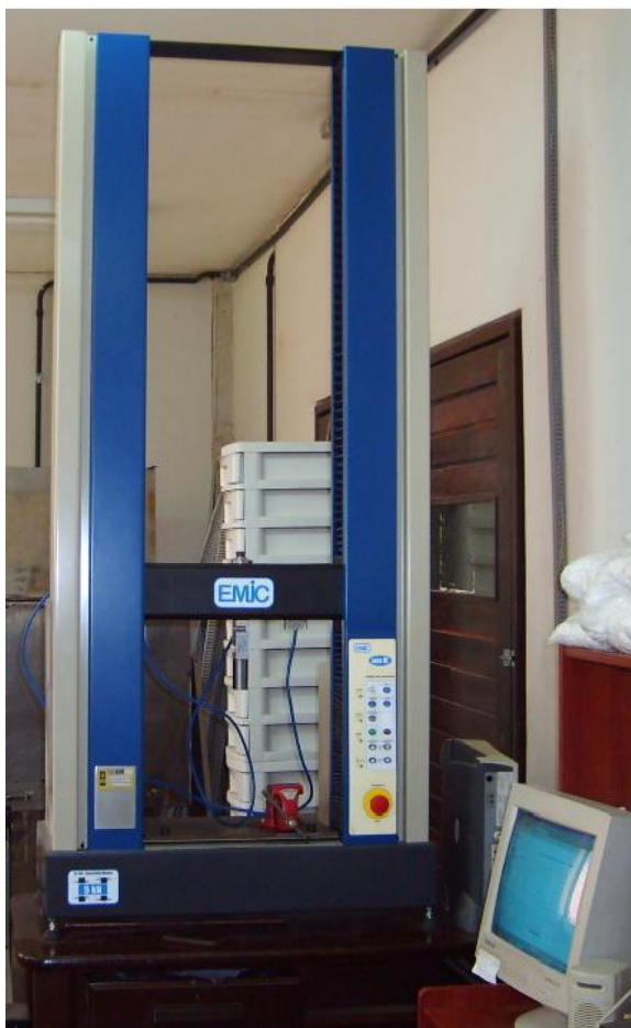
Figura 15: Máquina de ensaio EMIC DL500 utilizada nos ensaios de tração.
