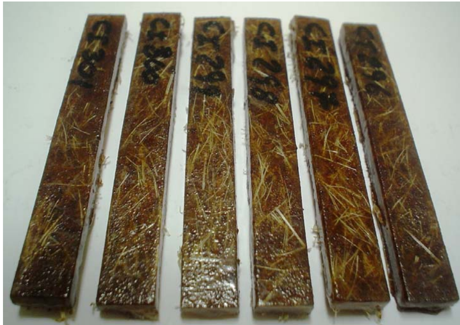
Figura 10: Corpos de prova de matriz poliéster reforçados por fibras de sisal e pó de madeira para ensaio de impacto Charpy.
