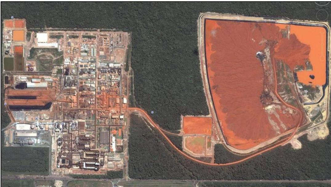
Figura 1.1 - Foto aérea da fábrica da Alunorte em Barcarena - PA destacando o depósito de rejeitos sólidos (DRS) onde é estocada a lama vermelha. Fonte: GOOGLE, (2009).
