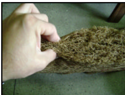
Figura 4.6 – Compressão lateral do painel de 18 kg/m 3 .
