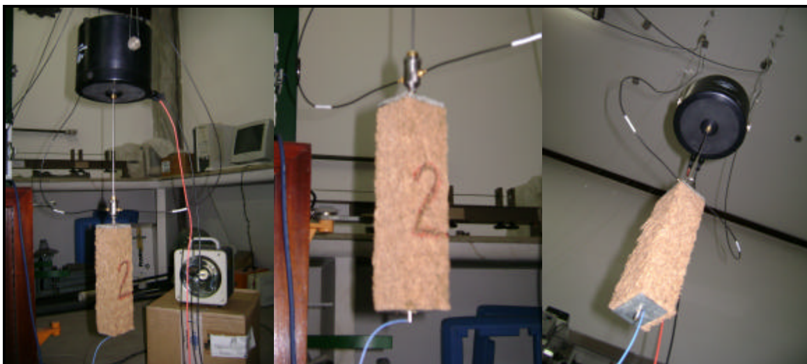
Figura 4.32 – Detalhes do ensaio para determinação do módulo de elasticidade dinâmico.
