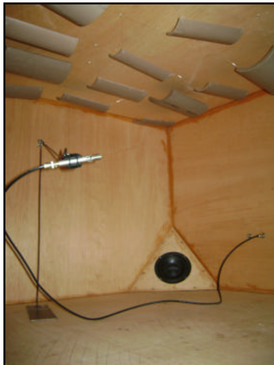
Figura 5.51 – Detalhe da fonte sonora, dos difusores e do suporte para o microfone no interior da mini-câmara reverberante.
