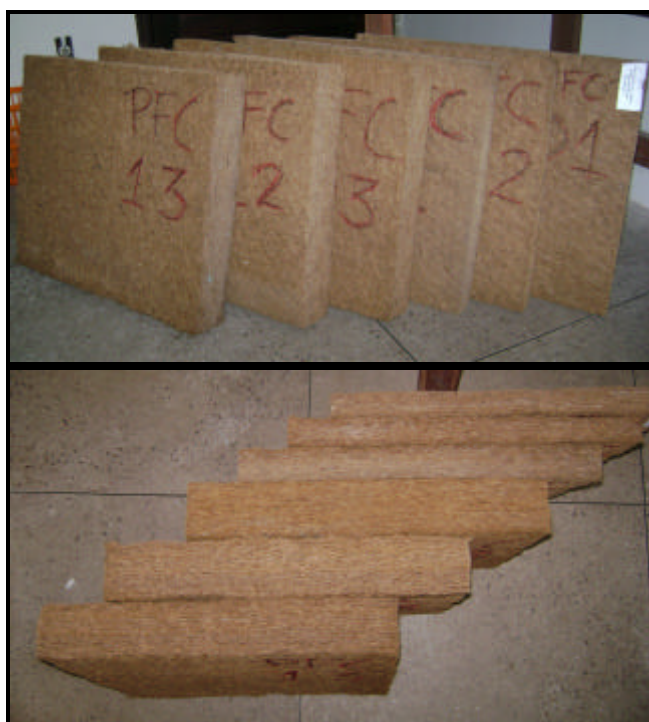
Figura 5.53 – Amostras do painel de 130 \text{ kg/m}^3 com 0,05 m e 0,1 m de espessura para o ensaio na mini-câmara reverberante.
