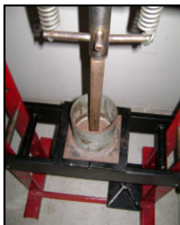
Figura 4.17 – Compressão da amostra durante o ensaio de porosidade.
