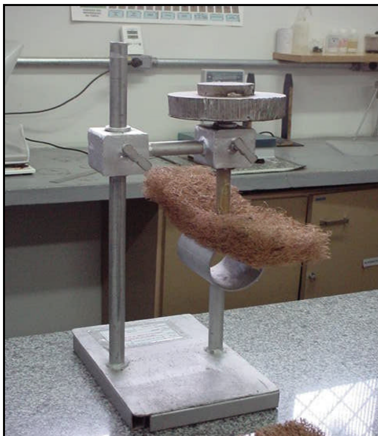
Figura 4.14 – Aplicação da carga de 5 kgf (indentador).
