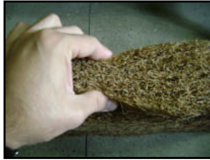
Figura 4.7 – Compressão lateral do painel de 60 kg/m 3 .
