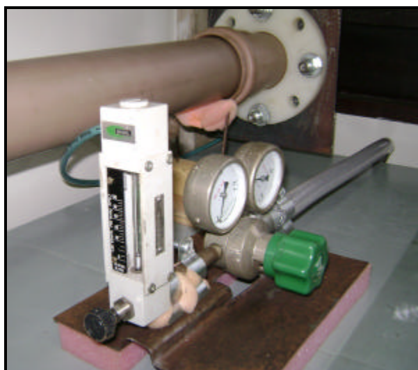
Figura 4.23 – Detalhe do rotâmetro na bancada para medição da resistividade ao fluxo.
