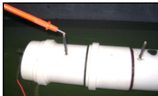
Figura 4.28 – Medição da diferença de potencial nas varetas da bancada de tortuosidade.
