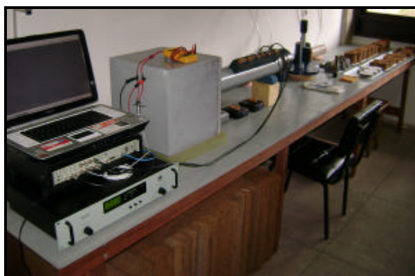
Figura 5.1 – Conjunto de medição do coeficiente de absorção normal – tubo de impedância.
