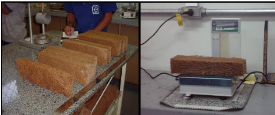
Figura 4.5 – Ensaio para determinação da densidade dos painéis.
