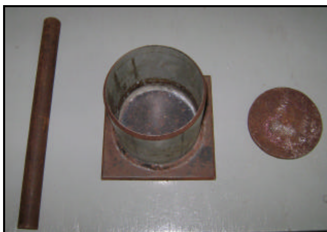
Figura 4.15 – Extensão, porta-amostras e superfície rígida utilizadas no ensaio de porosidade.
