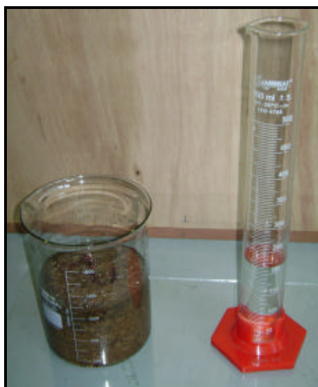
Figura 4.20 – Amostra imersa no beker e, ao lado, proveta para medição do volume deslocado.
