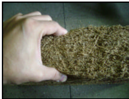
Figura 4.8 – Compressão lateral do painel de 130 kg/m 3 .
