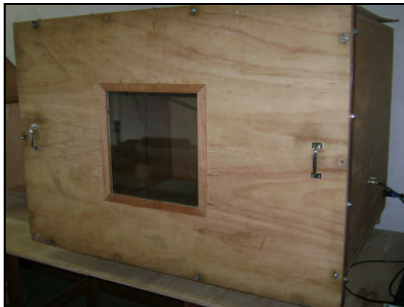
Figura 5.52 – Vista frontal da mini-câmara reverberante com um visor de vidro.
