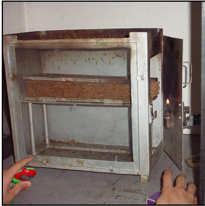
Figura 4.11 – Detalhe da cabine de combustão com o bico de busen aceso.
