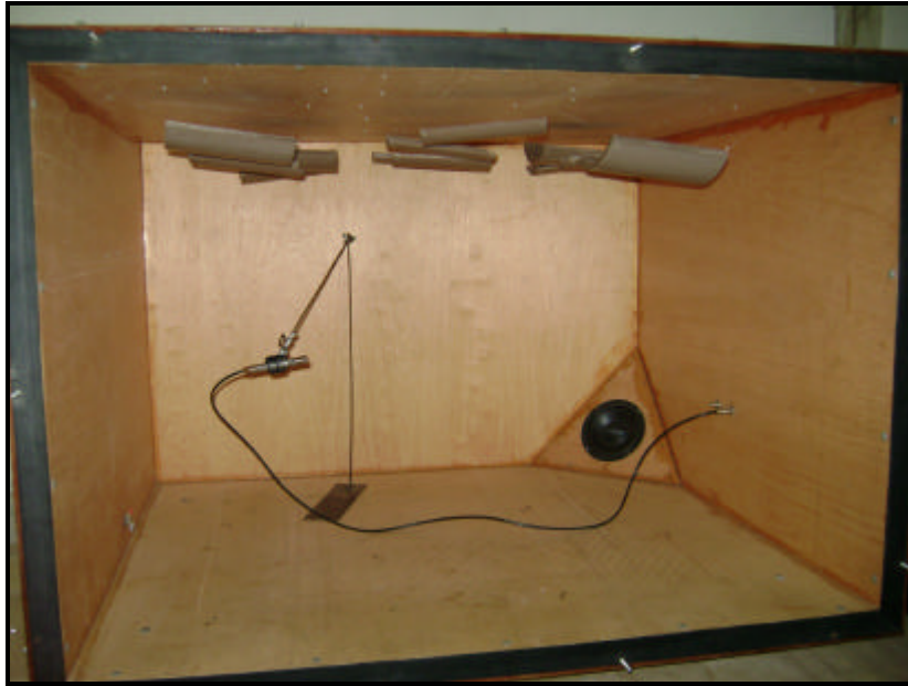
Figura 5.50 – Fonte sonora da mini-câmara reverberante.
