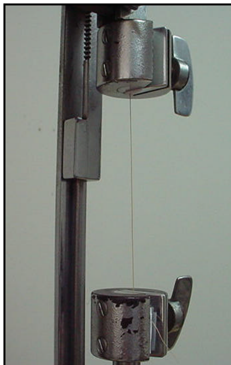
Figura 4.4 – Detalhe das garras e da fibra (máquina de tração).
