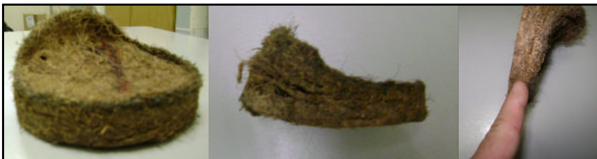
Figura 4.19 – Amostras de fibra de coco compactadas após o ensaio de porosidade.
