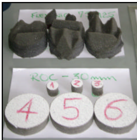
Figura 5.16 – Amostras dos painéis de espuma escolhidos para o ensaio nos tubos de impedância.
