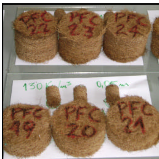
Figura 5.13 – Amostras do painel de 130 \text{ kg/m}^3 com 0,05 m e 0,1 m de espessura para o ensaio do tubo de impedância.
