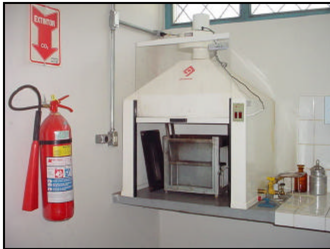
Figura 4.9 – Capela de exaustão com a cabine de combustão.
