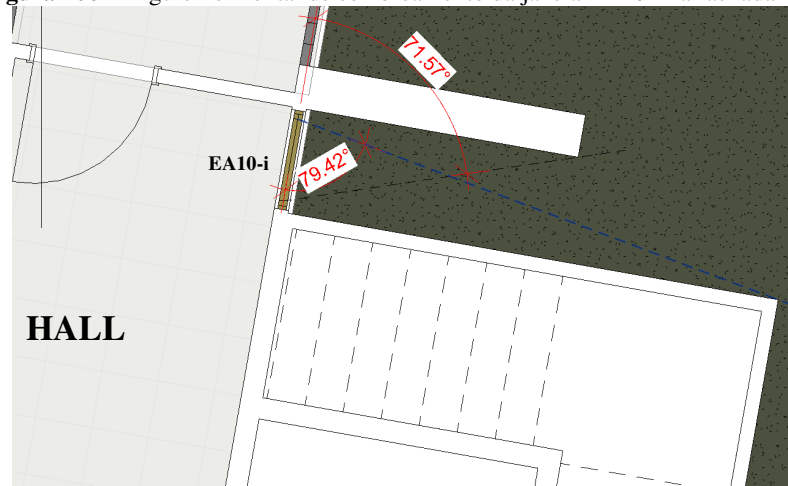
Figura 106 – Ângulo horizontal de sombreamento da janela EA10-i na fachada leste
