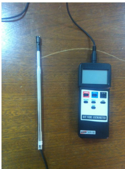
Figura 39 – Anemômetro digital de fio quente utilizado na sala de aula 2
