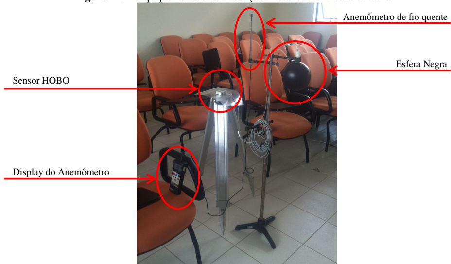
Figura 40 – Equipamentos de medição instalados na sala de aula 2
