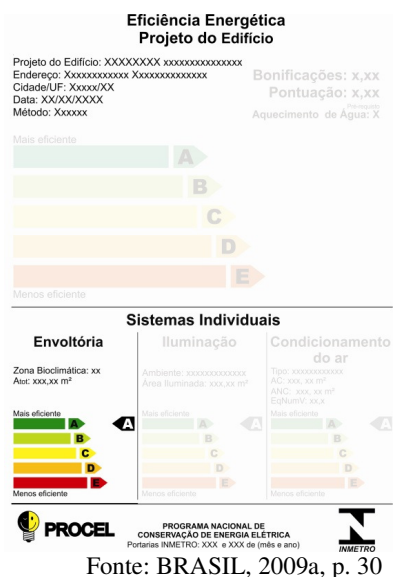
Figura 16 – Etiqueta Parcial para a Envoltória de Edificações
