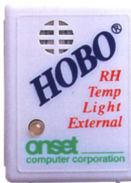
Figura 37 – HOBO da marca Onset utilizado nas medições
