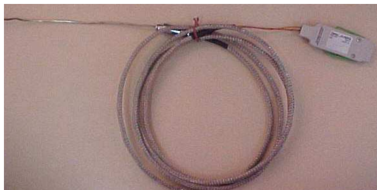
Figura 3.7 – Termopar de Chromel-Alumel do tipo K
