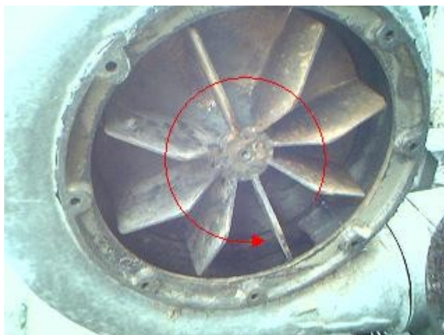
Figura 5-22 – Ventilador centrífugo do mecanismo de sucção.
