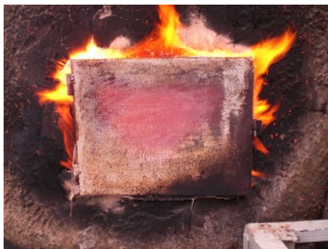
Figura 6-37 – Porta de vedação na janela de inspeção inferior durante um ensaio.
