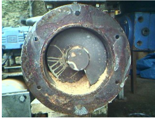
Figura 5-20 – Rosca sem-fim de alimentação de serragem.
