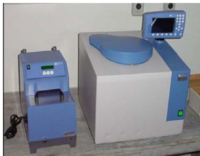
Figura 3.1: Bomba calorimétrica digital (Modelo C2000 Control, Ike Werke)
