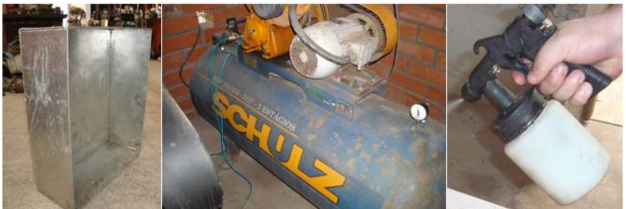
Figura 3.13 - Materiais utilizados para confeccionar os painéis, da esquerda para a direita: molde metálico, compressor rotativo e pistola de pintura.
