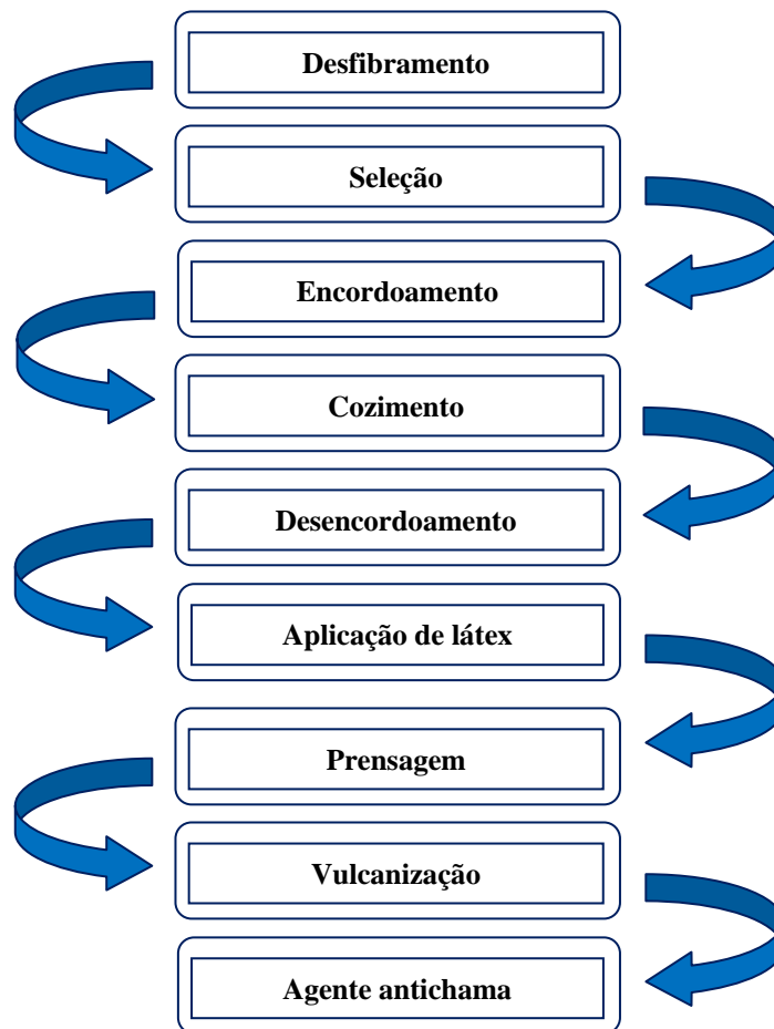
Figura 3.1 - Ciclo do processamento industrial da fibra de coco utilizado pela empresa POEMATEC.
