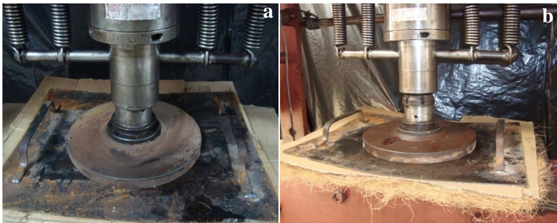
Figura 3.23 - (a) e (b) Camadas de fibras sendo prensadas.
