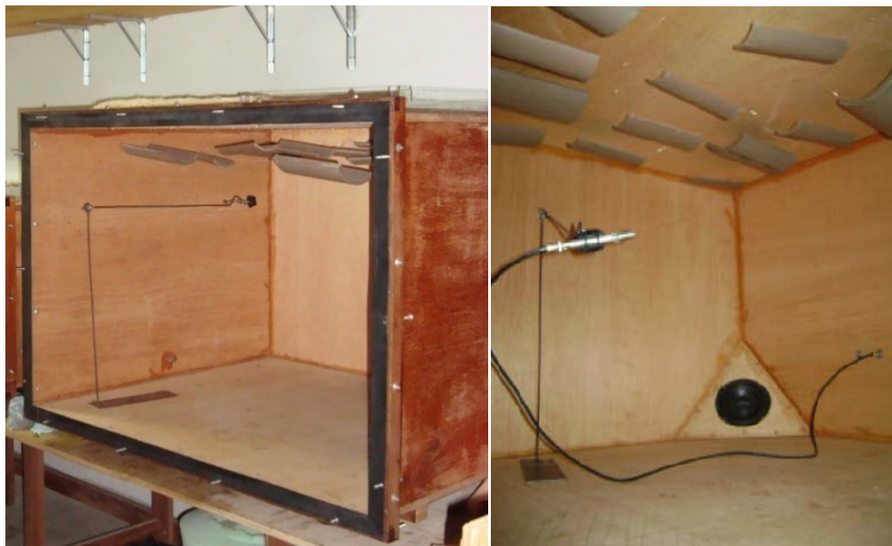
Figura 4.6 - Interior da minicâmara: seus difusores, fonte sonora e suporte do microfone.
