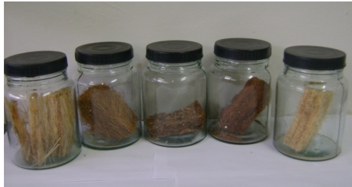
Figura 4.3 - Amostras de painéis de fibras vegetais prontas para o ensaio de odor.
