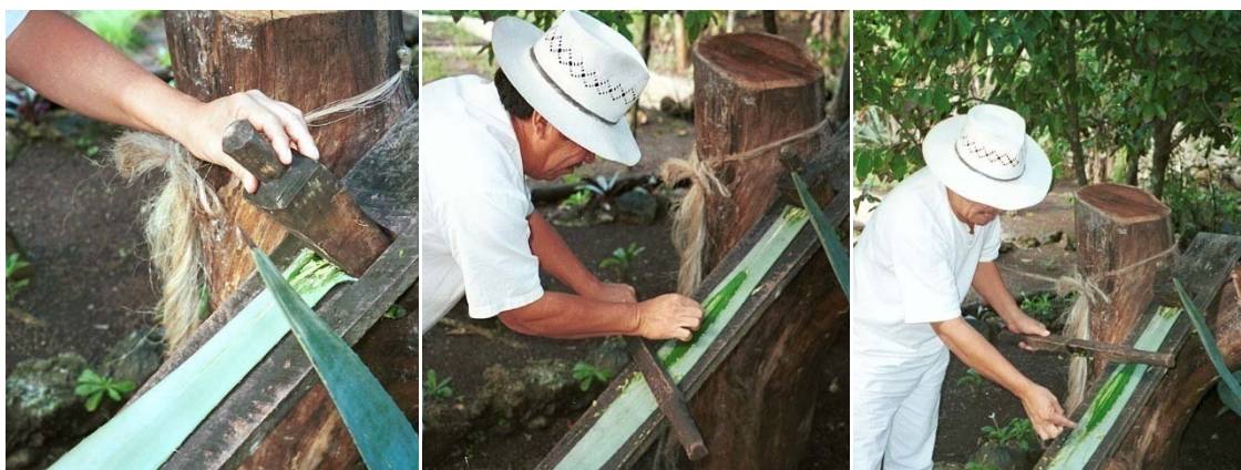
Figura 2.11 - Processo de extração artesanal da fibra do sisal.
