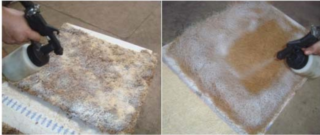
Figura 3.22 - Aplicação de aglomerante sobre as camadas de fibras.
