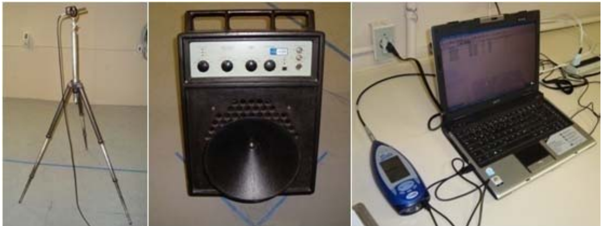
Figura 4.19 - Da esquerda para a direita: microfone, fonte sonora, medidor de nível de pressão sonora e computador.
