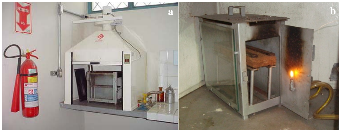
Figura 4.2 - (a) Capela utilizada para o ensaio de flamabilidade e (b) câmara de combustão.
