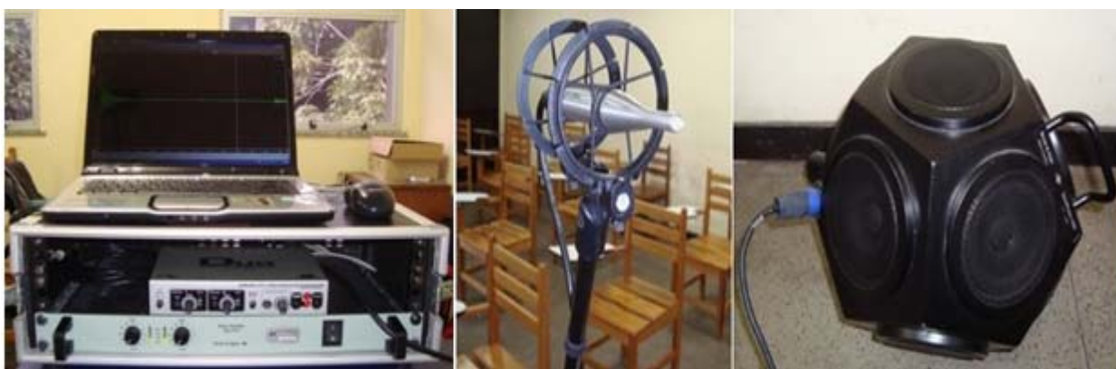
Figura 5.7 - Equipamentos utilizados para realizar as medições de tempo de reverberação, da esquerda para a direita: sistema de aquisição de dados, microfone omnidirecional e fonte sonora.
