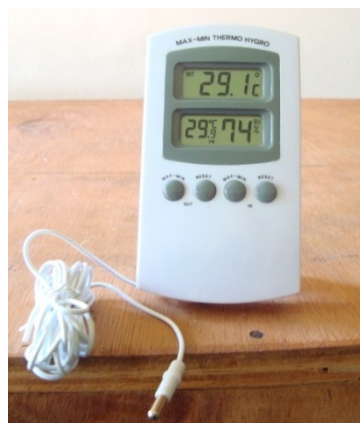
Figura 4.11 - Termo-higrômetro digital durante medição de temperatura e umidade relativa em um dia típico.
