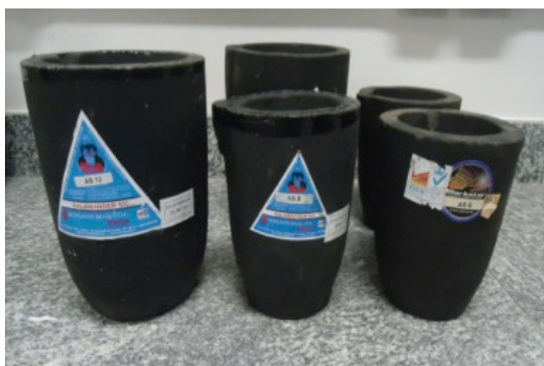
Figura 3.3 – Cadinhos de Carbetto de Silício (SiC)
