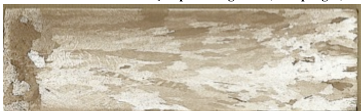
Figura 4.20 – Macroestrutura de solidificação para a liga Al-0,60%pMg-0,26%pFe-0,05%pCu
