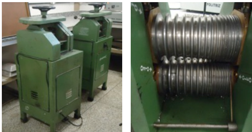
Figura 3.9 – Laminador duo elétrico MENAC
