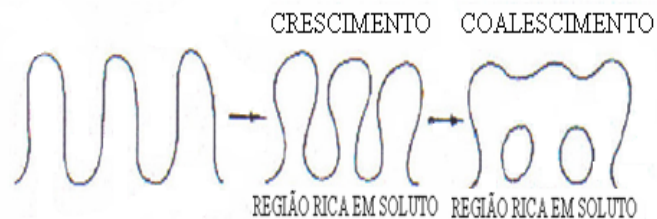
Figura 2.7 - Ilustração esquemática de processos alternativos de engrossamento dos braços dendríticos secundários (FLEMINGS, 1974; GARCIA, 2001).
