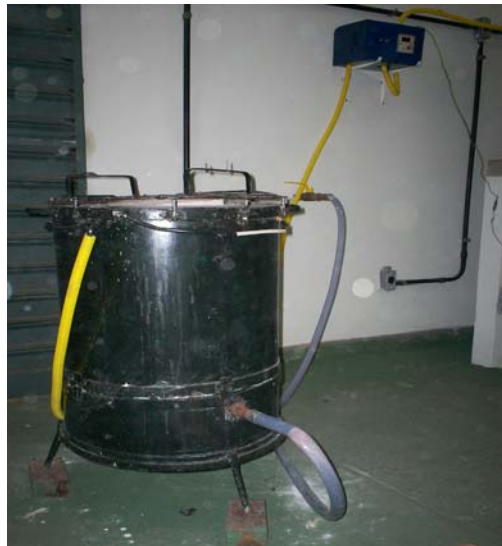
Figura 3.5 - Dispositivo de solidificação unidirecional vertical ascendente (RIBEIRO, 2007).
