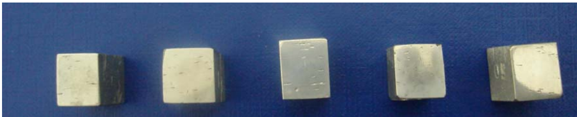
Figura 3.12 - Amostra retalhada para embutimento e observação por técnica de microscopia óptica.
