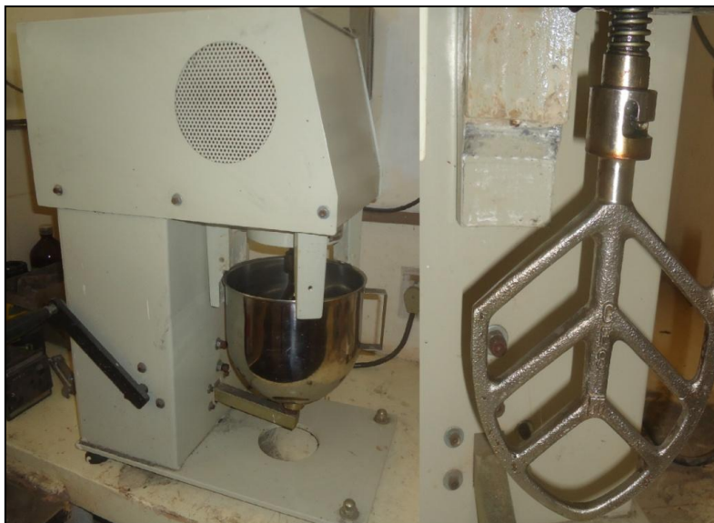
Figura 14: Misturador mecânico de movimento planetário, marca SOLDTEST com capacidade de 130 Litros.
