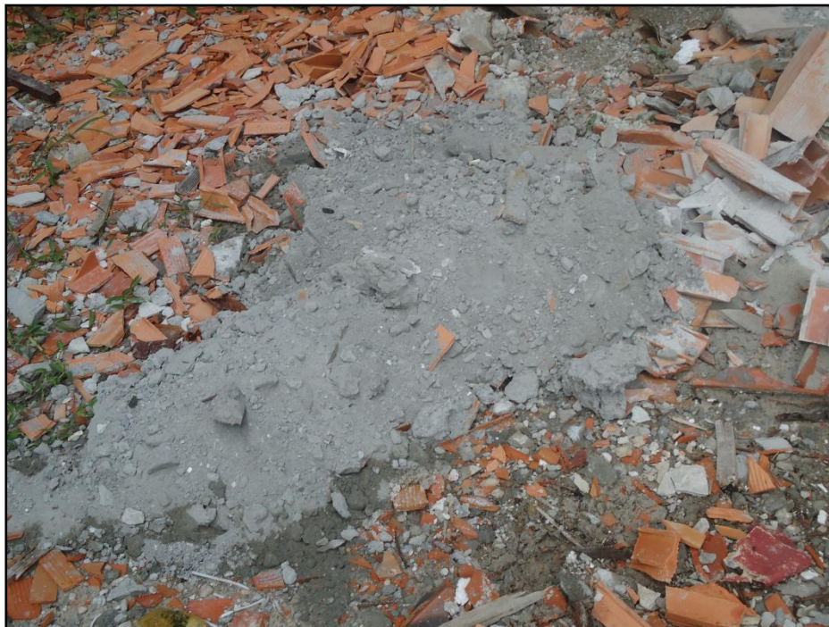
Figura 10: Rejeito da Construção Civil (RCC).
