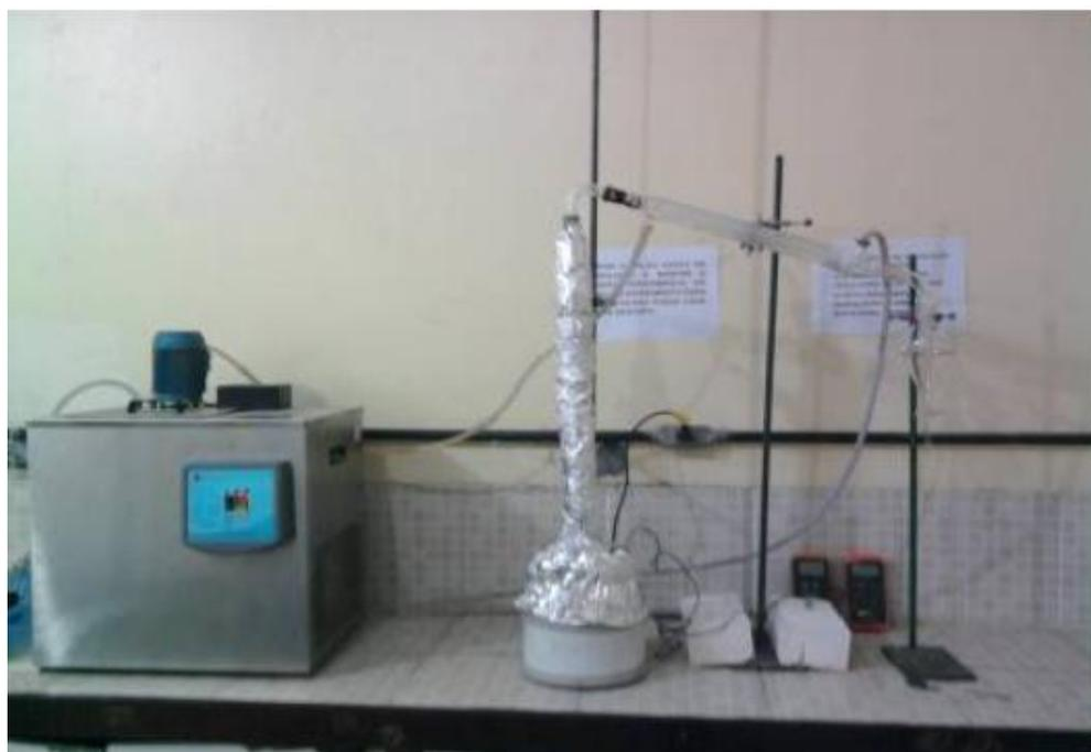
**Figura 20:** Sistema de destilação em escala de bancada
