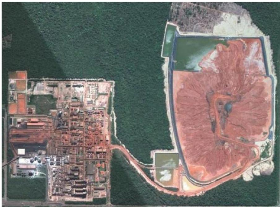
**Figura 11:** Vista aérea da fábrica e dalagoa de disposição de lama vermelha da Hydro-Alunorte (SANTOS, 2013).
