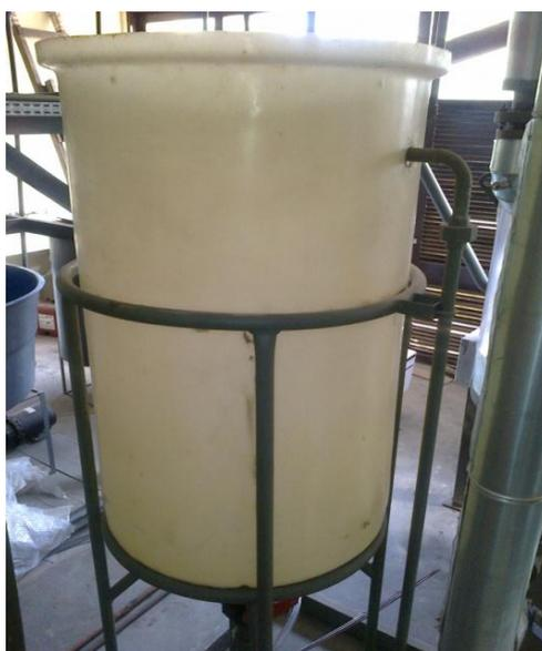
**Figura 12:** Tanque de polietileno (TQ01) com capacidade de 200L.
