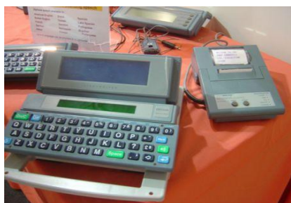
Figura 4- Lightwriter - Comunicador de voz sintetizada da empresa Zygo.
