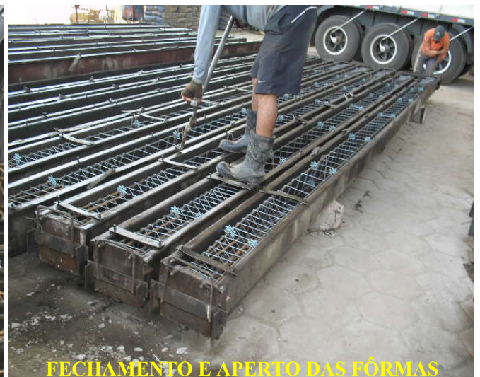
Figura 28: Montagem das fôrmas. Fonte: Barbosa, 2007.
