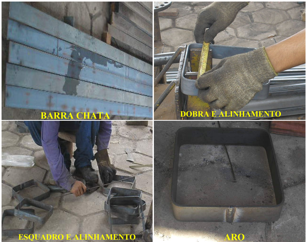
Figura 17: Primeira etapa da serralheria, com o processo de corte, dobra, solda, alinhamento e esquadro da barra chata, originando o aro.
