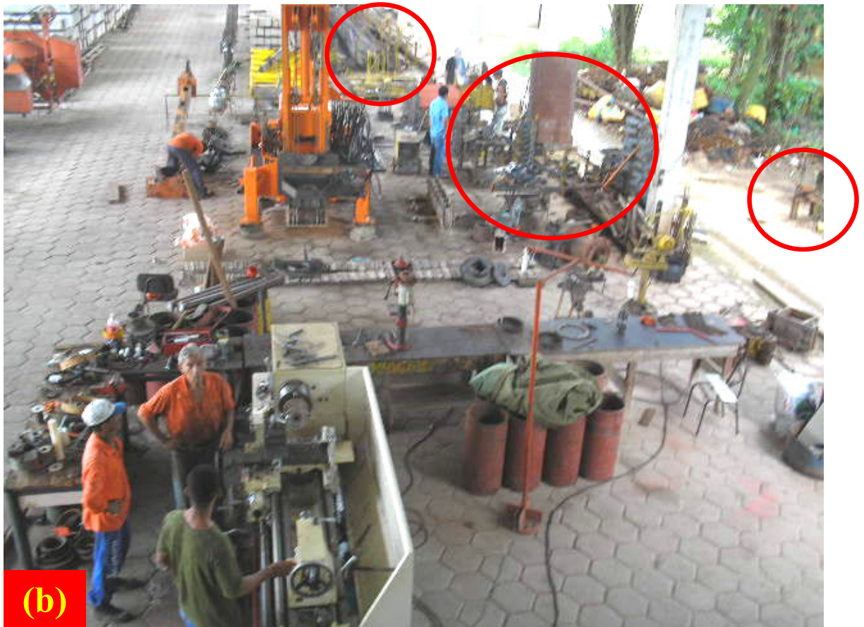
Figura 35: Equipamentos fora da linha de produção (Foto 1) e disposição física da serralheria e interrupções na linha de produção de estacas pré-moldadas.
