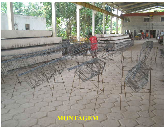
Figura 25: Montagem e armazenamento de armaduras.
