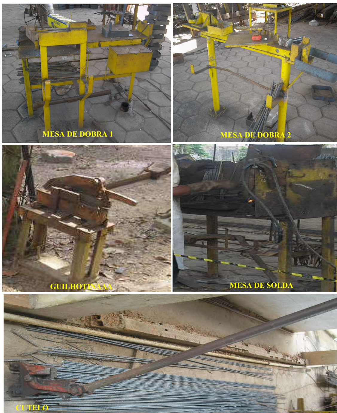
Figura 20: Equipamentos utilizados na fabricação do anel. Fonte: Barbosa, 2007.
