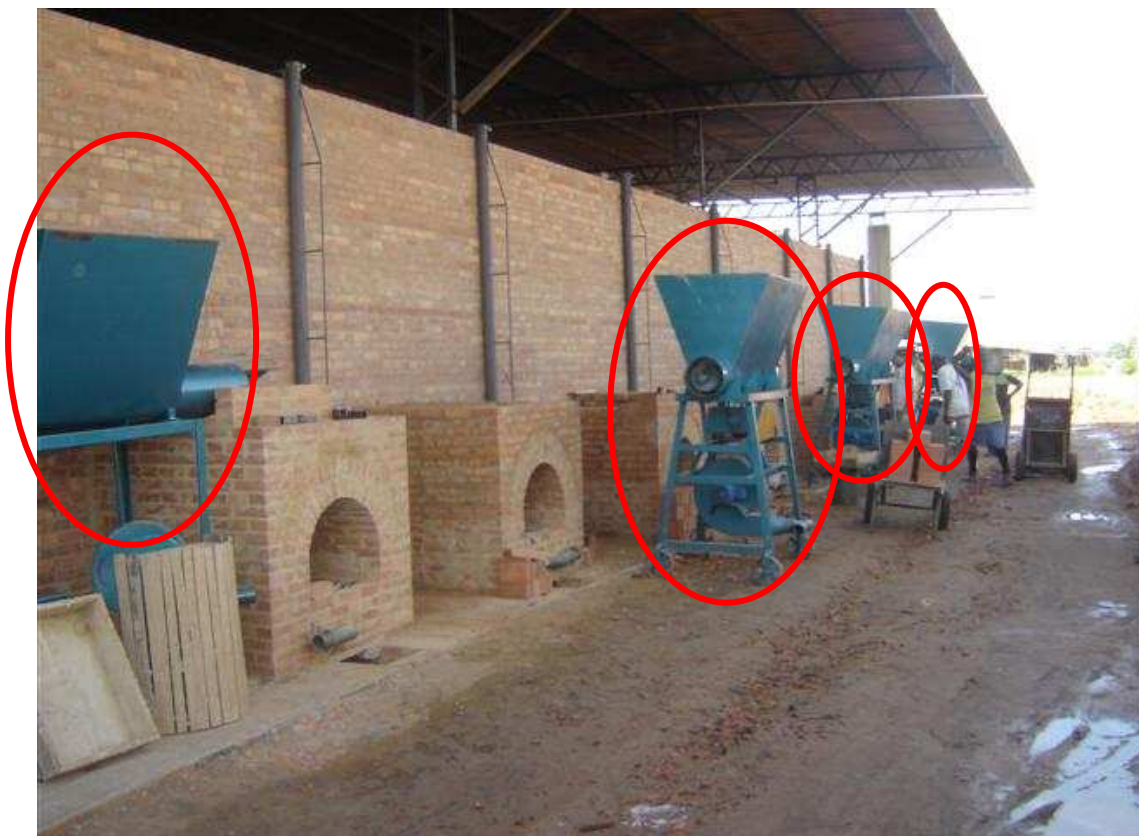
FIGURA 8.14 – Dosadores de biomassa para serem instalados nas fornalhas dos fornos Fonte: Cerâmica Gama LTDA
