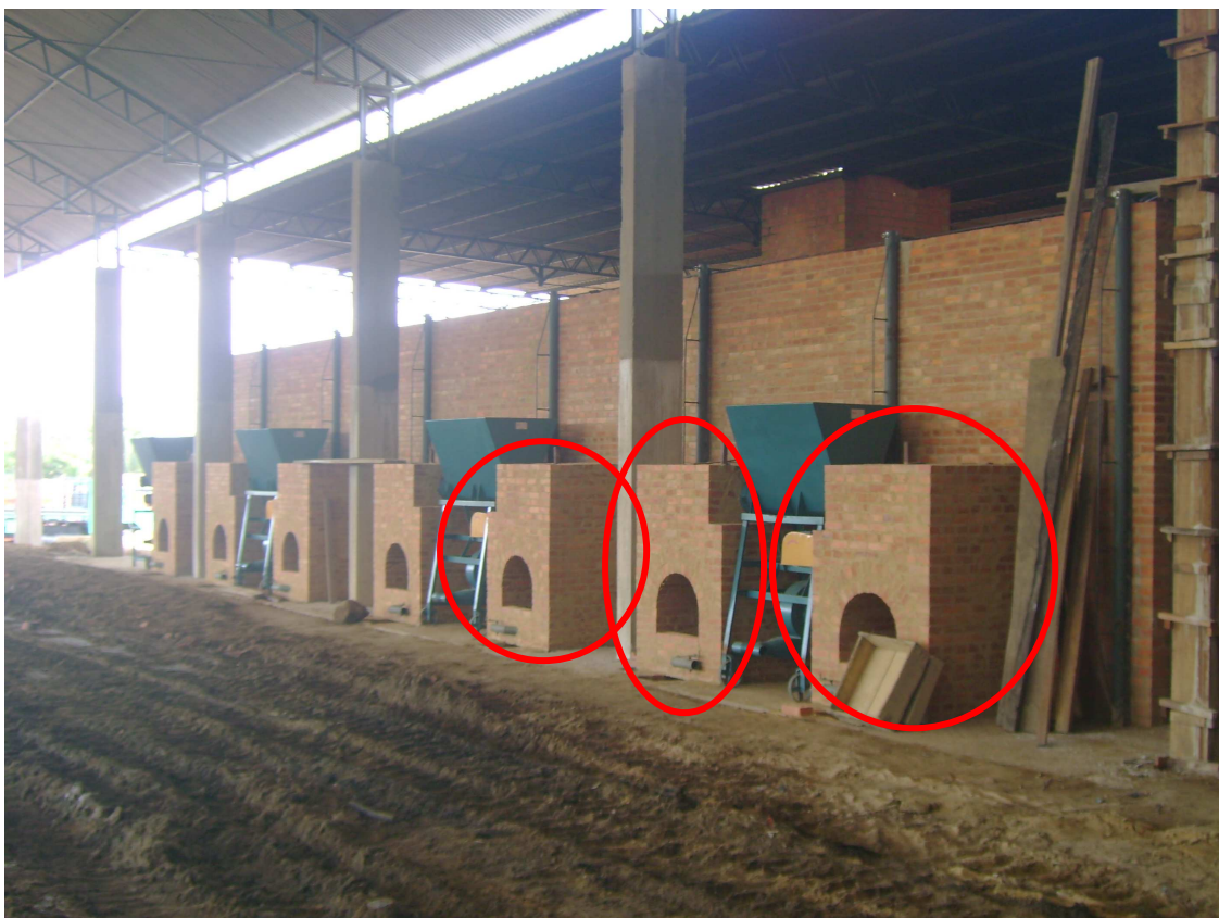
FIGURA 8.11 – Adaptação nas fornalhas dos fornos para receber os dosadores de biomassa Fonte: Cerâmica Gama LTDA
