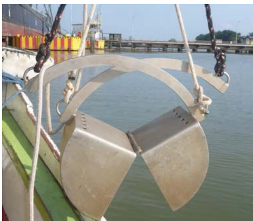
Figura 10: Draga do tipo Petersen utilizada na coleta das amostras sedimento.
