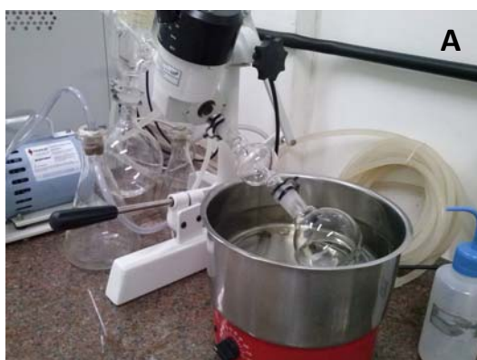
Figura 15: Troca de solventes e concentração do extrato em (A) evaporador rotativo e (B) sob fluxo de nitrogênio.
