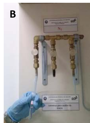
Figura 15: Troca de solventes e concentração do extrato em (A) evaporador rotativo e (B) sob fluxo de nitrogênio.
