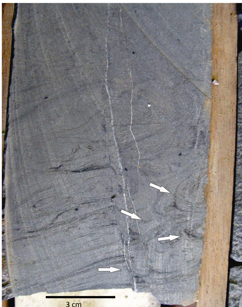
Figura 21 - Siltito com laminação cruzada de baixo ângulo e base reta, em detalhe (setas brancas) laminações convolutas.
