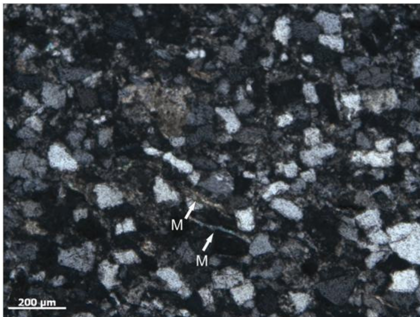
Figura 45 - Micas contorcidas com extinção ondulante devido à compactação física dos grãos.
