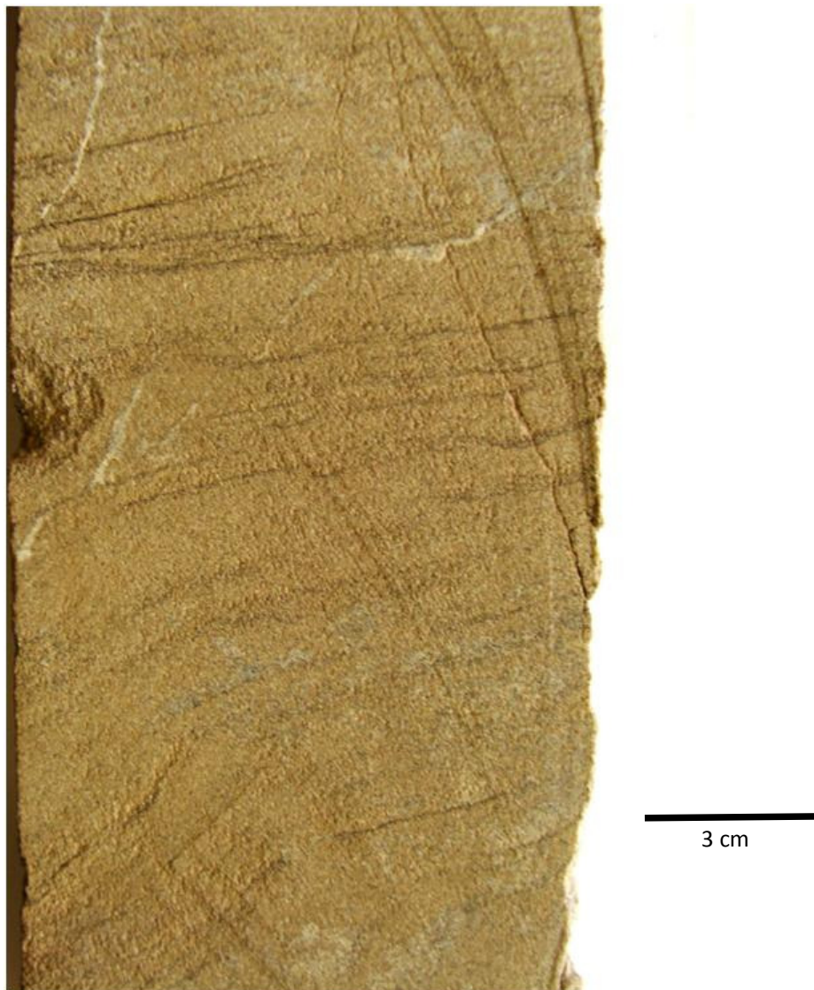
Figura 22 - Arenito fino a grosso com estratificação cruzada acanalada, localmente deformada, com drapes de argila cobrindo os foresets .
