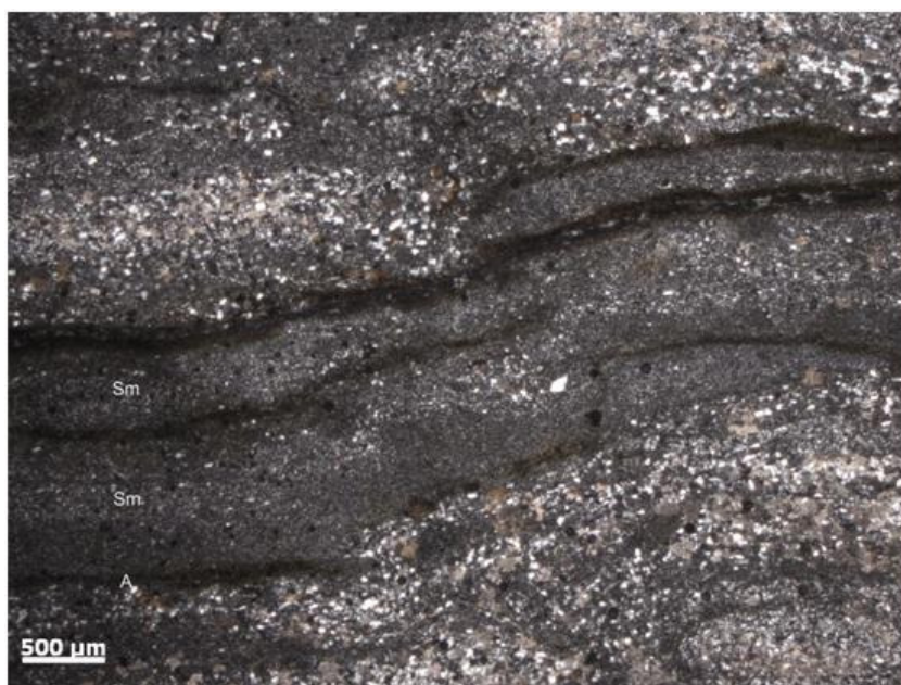
Figura 62 - Silicificação parcial da matriz dolomítica por quartzo microcristalino (Sm) intercalado com argila (A), dolomita e grãos terrígenos na microfácies Ds.
