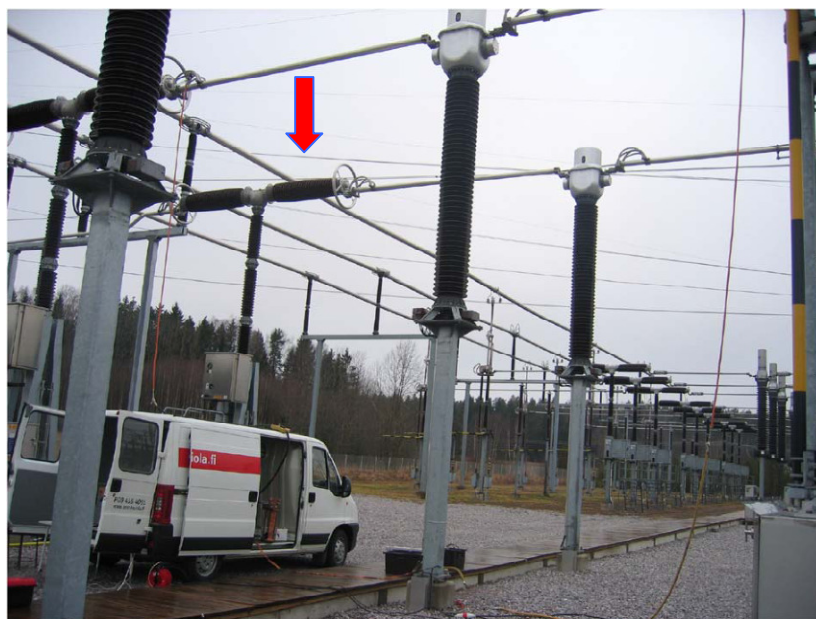
Figura 6 – Arranjo da calibração in situ . Bobina de Rogowski em destaque. Os instrumentos de medição e a fonte de corrente estão no interior da van.
