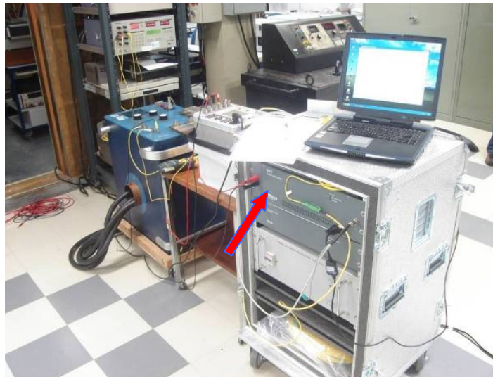
Figura 20 – Arranjo dos instrumentos e padrões na calibração do transdutor ótico NXCT-F3.
