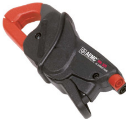
Figura 15 – Alicate amperímetro AEMC MN306, utilizado para medição da corrente do secundário do TC sob verificação.
