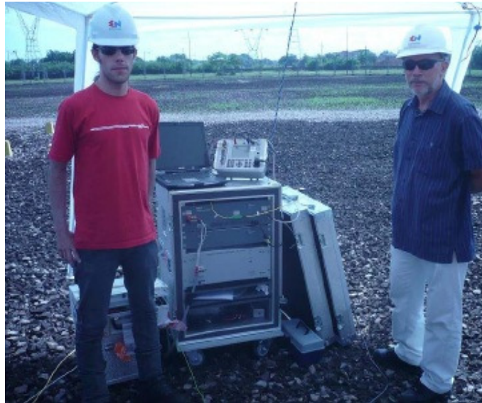
Figura 36 – Módulo eletrônico do transdutor ótico NXCT-F3 do SVTC, juntamente com o comparador de correntes Arbiter 933A no pátio da SE Utinga.
