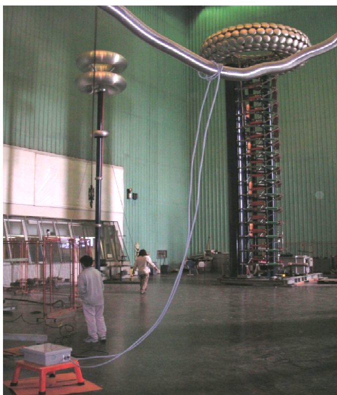
Figura 28 – Montagem do circuito para o ensaio de tensão aplicada do transdutor ótico NXCT-F3.
