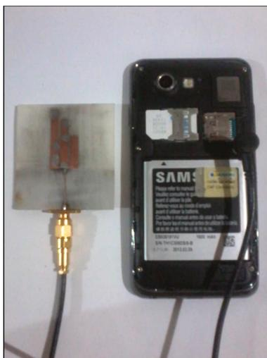
Figura 5.12. Setup de conexão entre antena e o aparelho
