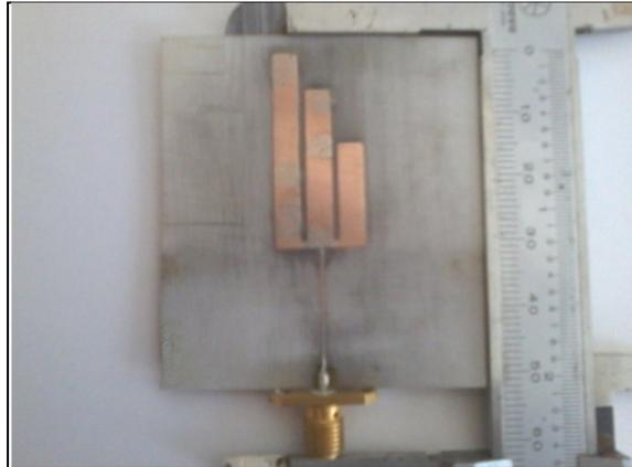
Figura 5.2.(a). Imagem de frente do protótipo da antena proposta
