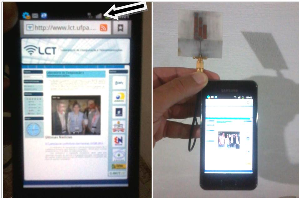
Figura 5.14. Dispositivo com a antena conectada no cabo
