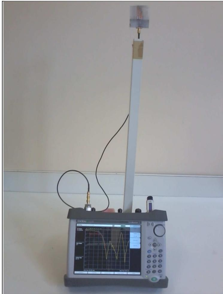
Figura 5.3. Setup de medição dos parâmetros de reflexão da antenna proposta
