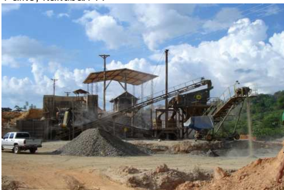
Foto 2 - Pátio industrial: britagem da Mina do Palito, Itaituba/PA
