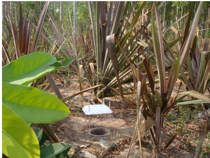
FIGURA 20: Armadilha para captura de pedofauna, implantada na Fazenda Tramontina Belém S/A. Aurora do Pará. Adaptada a partir do modelo de “pitfall traps”.
