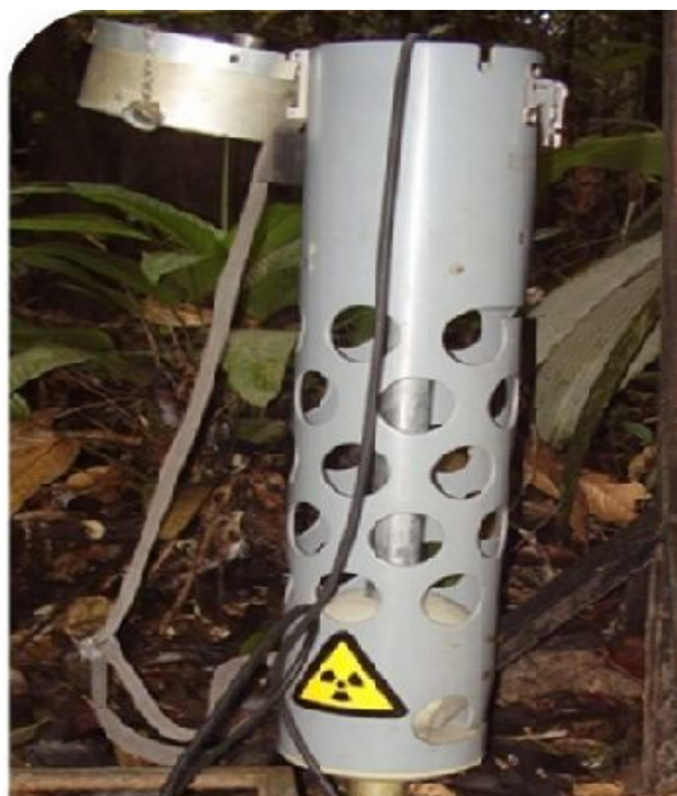
Figura 3 – Sonda de nêutrons utilizada para medir a umidade do solo nos pontos de coleta T1, T2 e T3 próximos à estação meteorológica K34, na Reserva Biológica do Cuieiras (Manaus-AM).
