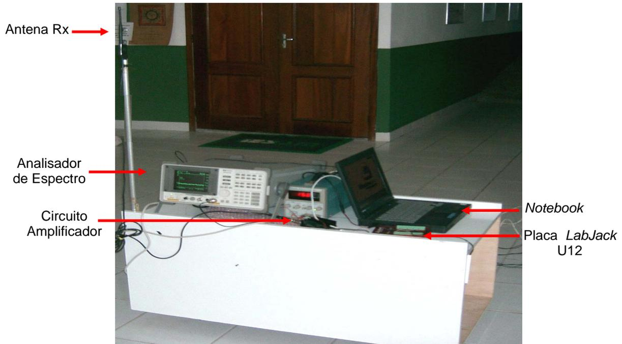
Fig. 3.5 - Módulo Receptor
