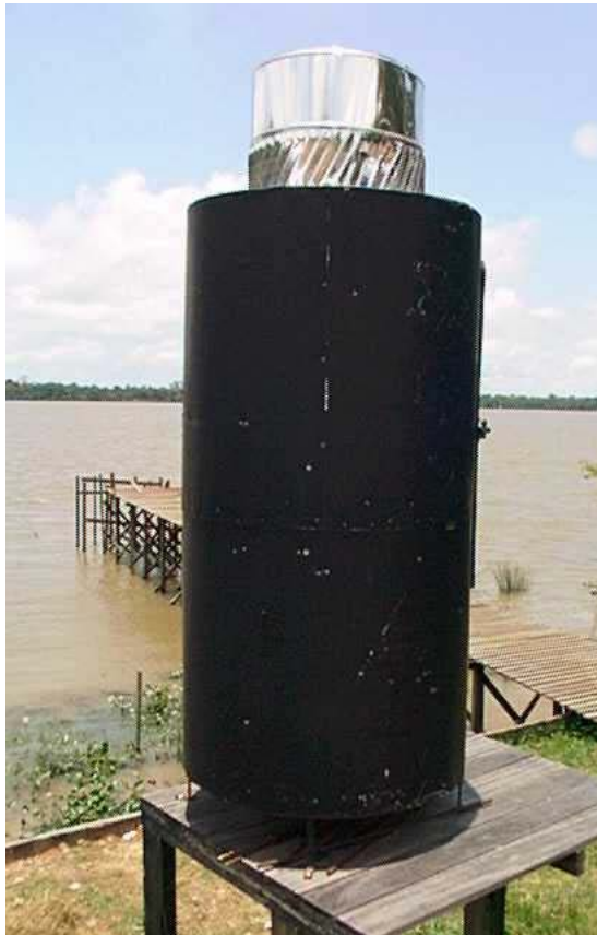
Figura 4.55 – Secador solar-eólico na área de testes da FCAP.
