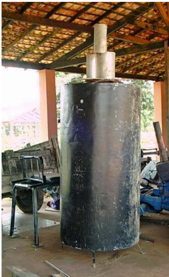
Figura 4.56 - Secador solar-eólico com rotor Savonius.
