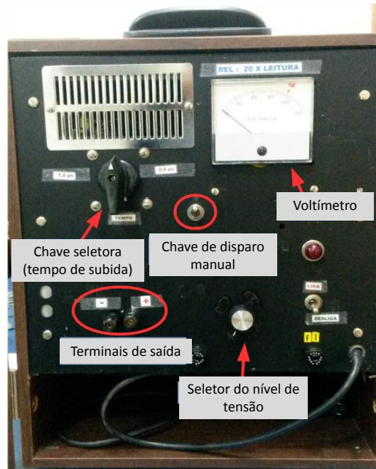
Figura 3.10: Painel frontal do gerador de surto utilizado nos experimentos.
