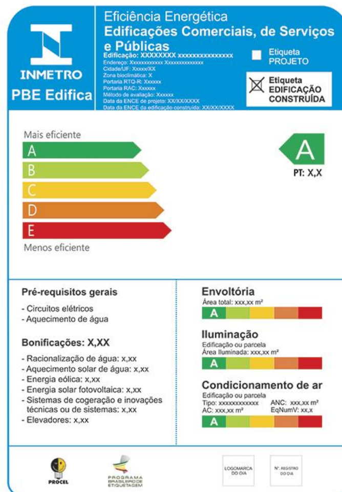
Figura 3 – ENCE Geral de Edificação Construída.
