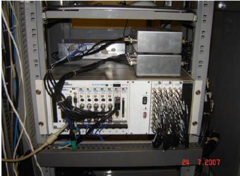
**Figura 5.10 - Sistema IMA-DP - Plataforma PXI com Filtros de DP e Divisores de Tensão para o Sinal de Sincronismo**
