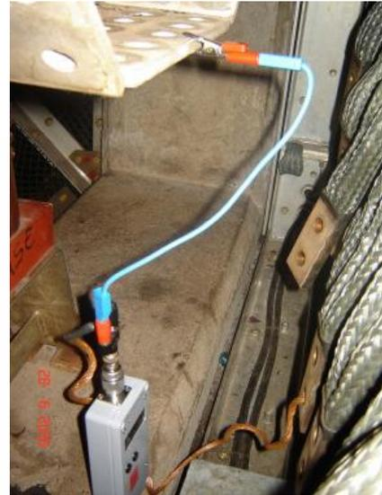
**Figura 4.10- Circuito de Calibração e o Calibrador Instalado nos Terminais da Máquina**
