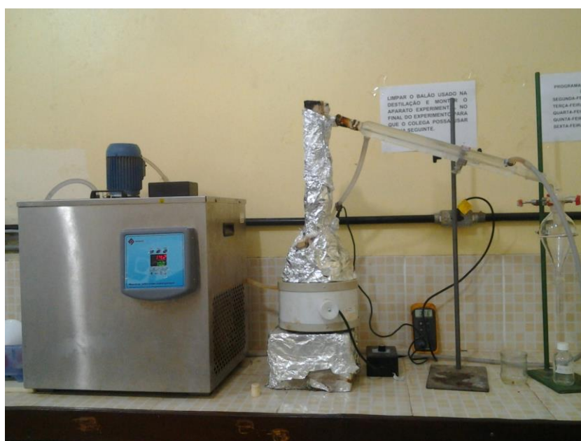
Figura 3 12 Unidade de destilação fracionada em escala de bancada.
