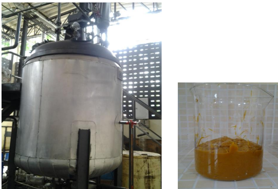
Figura 3 1 Reator com sistema de agitação e a borra desidratada proveniente da neutralização do óleo de palma ( Elaeis Guineensis ).
