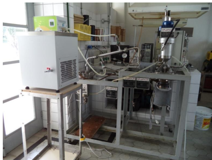
Figura 3 6 Unidade de Craqueamento em Escala semipiloto
