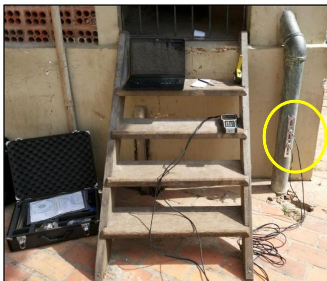
Figura 12 - Ponto de instalação dos transdutores
