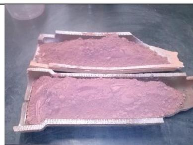
Figura 35- Lama calcinada a 1000 °C
