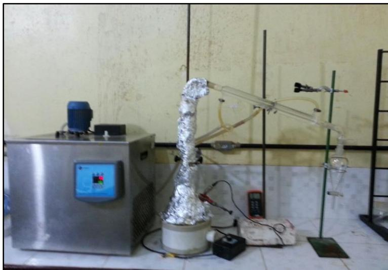
Figura 38 - Unidade de destilação em escala de bancada
