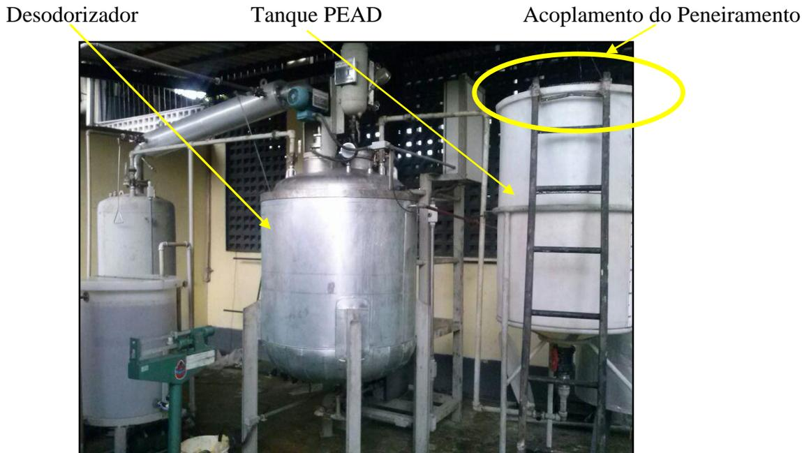
Figura 26- Unidade Piloto de Desodorização/Desidratação de 750 L
