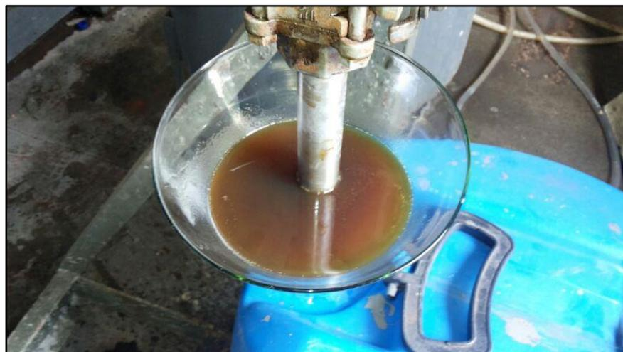
Figura 31- Coleta de PLO no vaso de coleta
