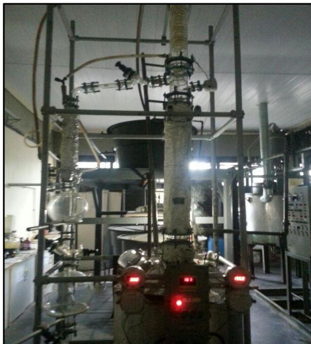
Figura 37 - Unidade de Destilação Piloto/THERMTEK/LEQ/ITEC/UFPA
