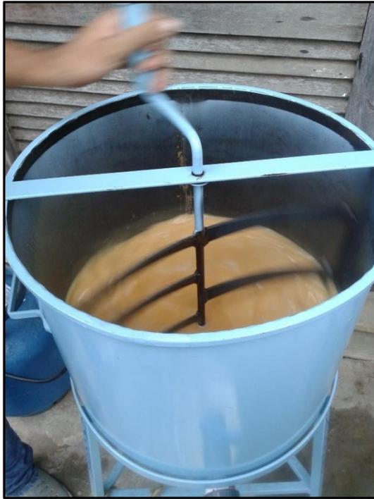
Figura 28 - Tacho de reação de saponificação
