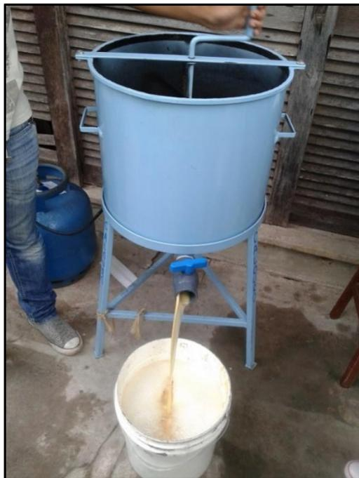
Figura 29 - Coleta do produto da reação de saponificação.
