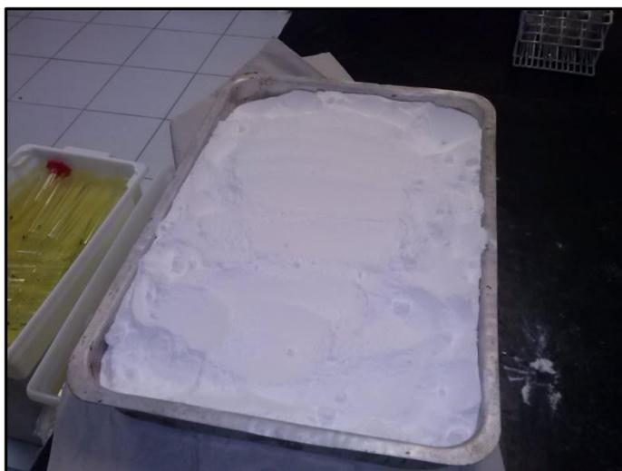
Figura 32 - Catalisador  $\text{Na}_2\text{CO}_3$  seco.
