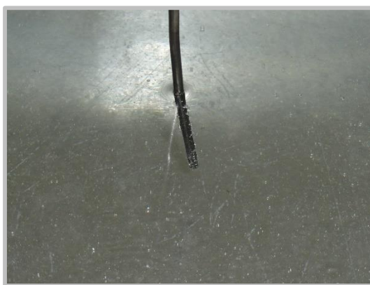
Figura 4.47 - Formação de bolhas no fundo da panela mestra e no termopar Foto: Tiago Santos
