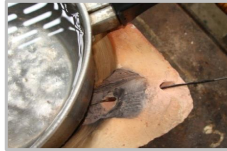
Figura 3.17 - Localização do termopar de controle.
