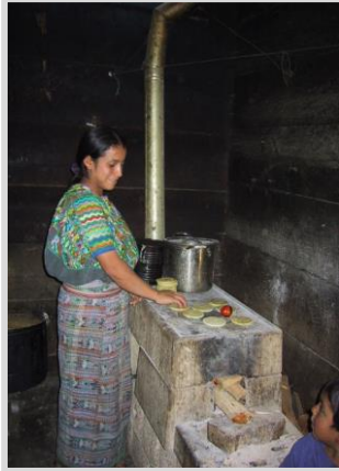
Figura 2.1 - Fogão com uma chaminé - projetada pela Helps na América Central Fonte: Practical Action foto: HELPS international
