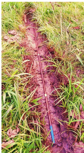
Valeta + haste de injeção de corrente
