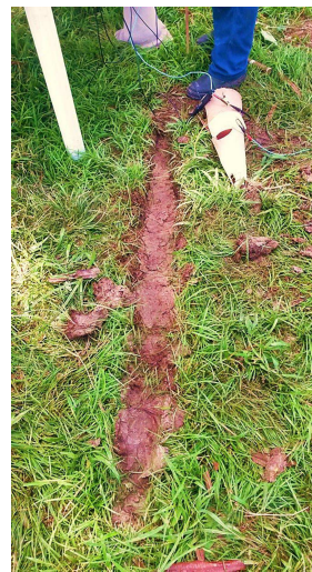
Haste de injeção de corrente enterrada
