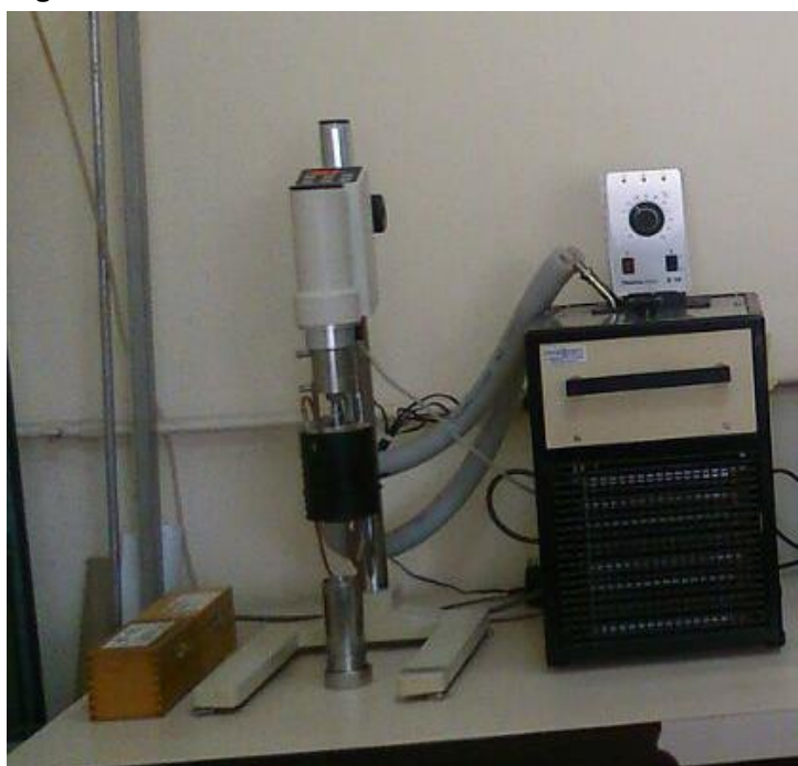
Figura 16 – Viscosímetro rotacional Haake VT
