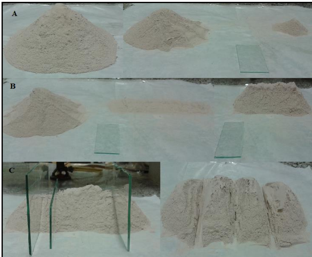
Figura 19. Quarteamento realizado na amostra de Minério aurífero proveniente do Garimpo Divisão. A) Formação da pilha cônica, B) Formação da pilha longitudinal piramidal, C) Separação e quarteamento das amostras coletadas. Fonte: Autor.
