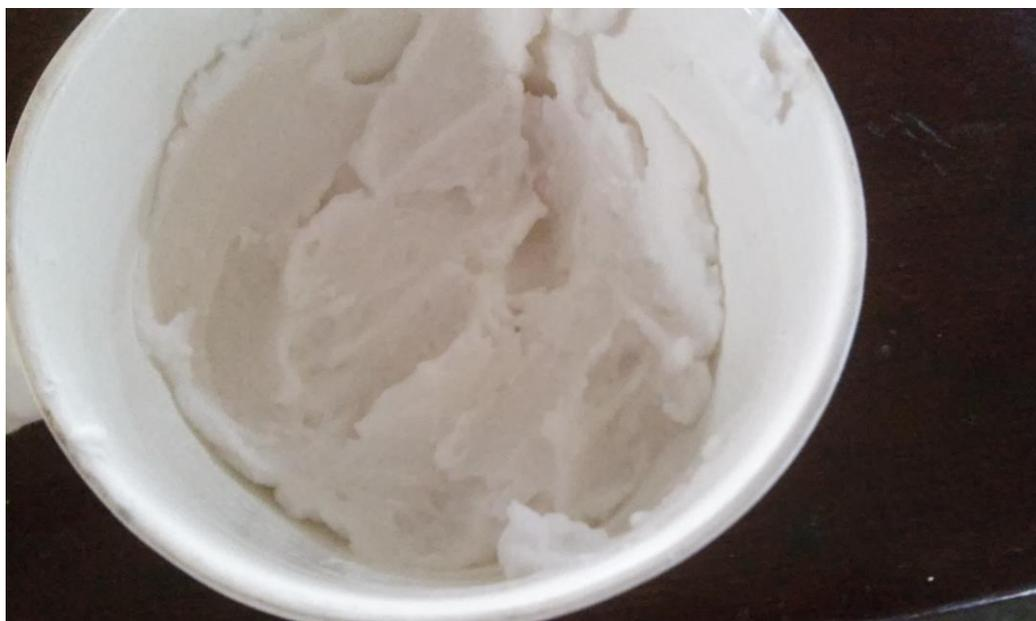
Figura 9. Gel seco em estufa após 24 h
