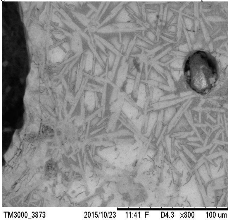
Figura 4.36: MEV do material sinterizado - Terceiro experimento
