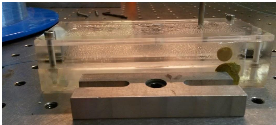
Figura 4.22–Foto da câmara de acrílico de análise experimental de temperatura.
