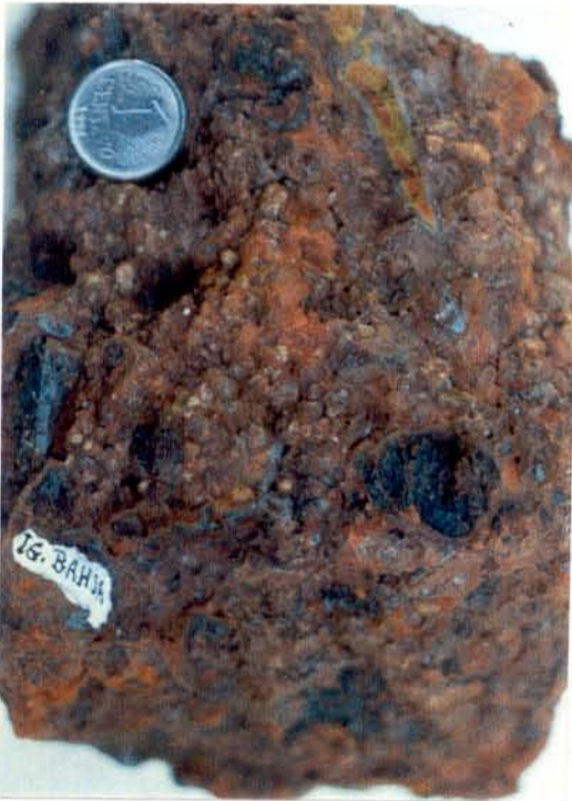
Figura 2.12 - Texturas pisolíticas finas, em crosta laterítica da área Igarapé Bahia, de coloração avermelhada e contendo fragmentos terrosos centimétricos de gossans.
