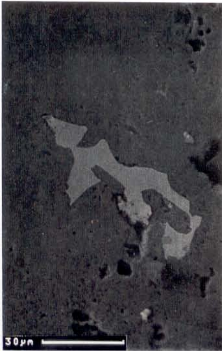
Figura 2.86 - Partícula de Au associada à crostas lateríticas na área Águas Claras (MEV). Amostra BF-888 (Docegeo).
