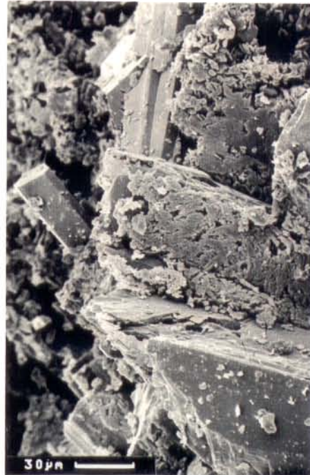
Figura 2.42 - Estágio mais avançado da destruição dos cristais de dravita ao longo do furo 44, Águas Claras (MEV).
