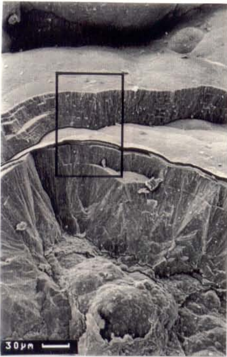
Figura 2.59 - Pequenos filmes de gibbsita intercalados às camadas goethíticas nas concreções ferruginosas (MEV).
