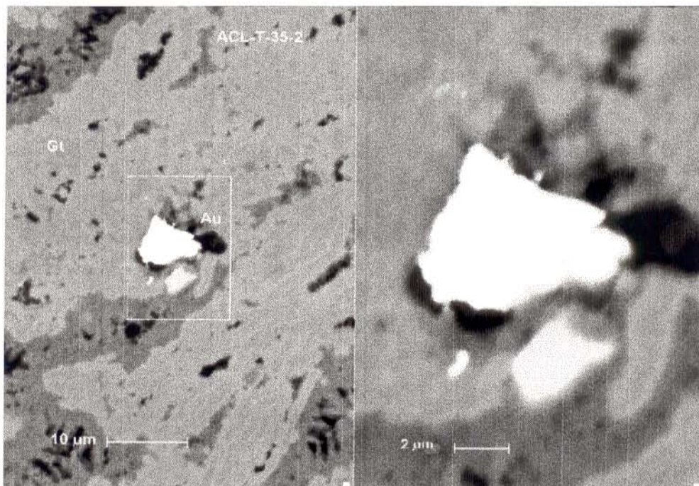
Figura 2.82 - Partícula de Au associada a gossan na amostra ACL-TR-35-23, Águas Claras (MEV).
