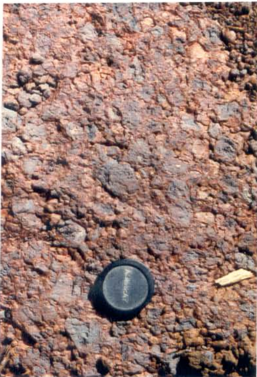
Figura 2.10 - Detalhe da Figura 2.9: crosta ferruginosa laterítica na mina Igarapé Bahia, com textura pseudo brechóide a pseudo-pisolítica, exibindo fragmentos hematíticos derivados dos gossans.
