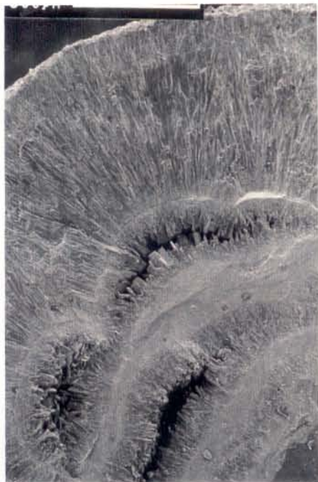
Figura 2.53 - Cristais de goethita formando drusas no núcleo de concreções ferruginosas, na crosta laterítica da área Igarapé Bahia.
