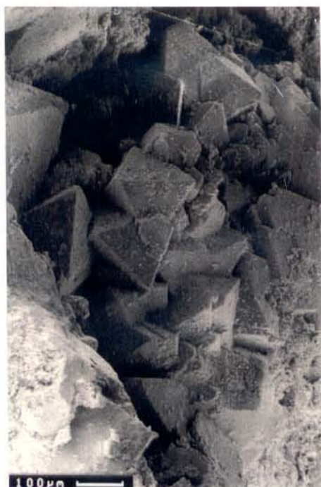
Figura 2.47 - Feição textural dos gossans da área Águas Claras, observada ao MEV, destacando cristais de hematita pseudomórficos segundo octaedros de magnetita.
