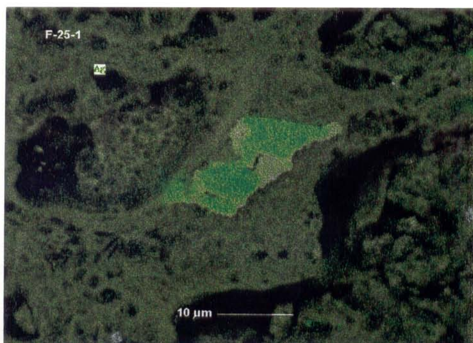
Figura 2.89 - Imagens do mapeamento geoquímico da Ag (verde) com o MEV-EDS, em grão de ouro associado a crostas lateríticas, do F-25, na área Águas Claras.
