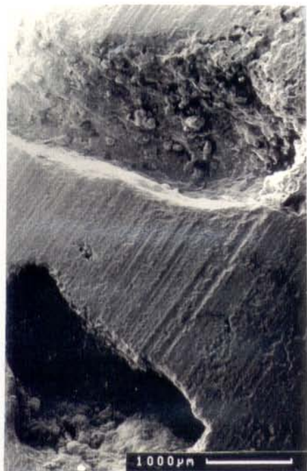
Figura 2.57 - Cavidades na crosta laterítica da mina Igarapé Bahia, onde são observados cristais euédricos de gibbsita (MEV).
