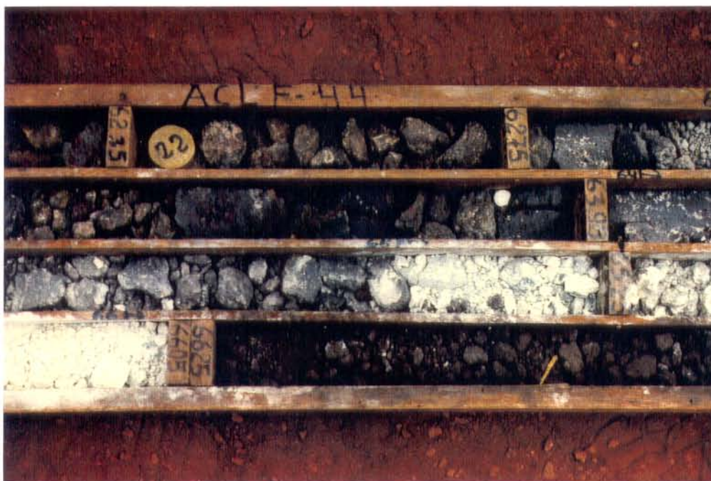
Figura 2.23 - Níveis métricos de caulim hidrotermal intercalados aos gossans em diferentes testemunhos de sondagem na área Águas Claras.
