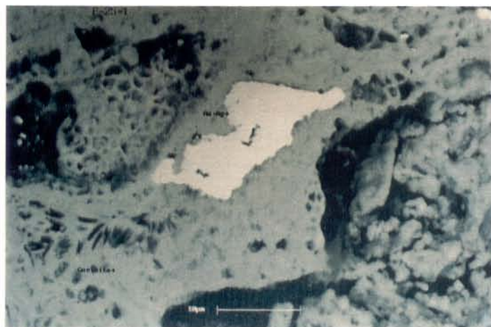
Figura 2.88 - Partícula de Au associada à crostas lateríticas na área Águas Claras (MEV). Amostra do F-25-1 (Docegeo).
