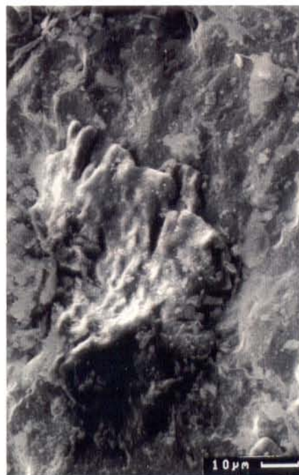
Figura 2.76 - Películas de material ferruginoso na superfície das partículas de Au da Figura 2.75 (ponto 5 da Tabela 2.23).
