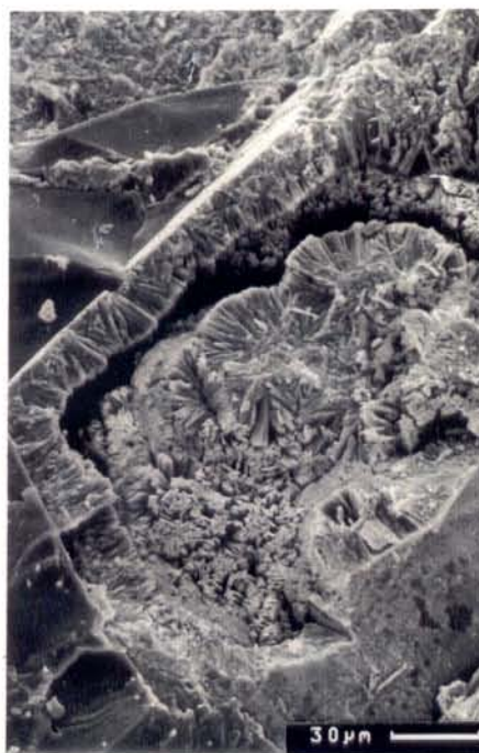
Figura 2.56 - Cristais aciculares de goethita, preenchendo cavidades romboédricas deixadas pela dissolução de carbonatos, nos gossans da área Águas Claras (MEV).
