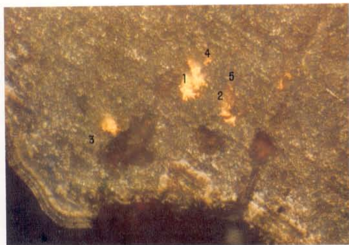
Figura 2.79 - Partículas de Au da Figura 2.78, associadas aos gossans, fotografadas ao microscópio petrográfico (nicóis //).
