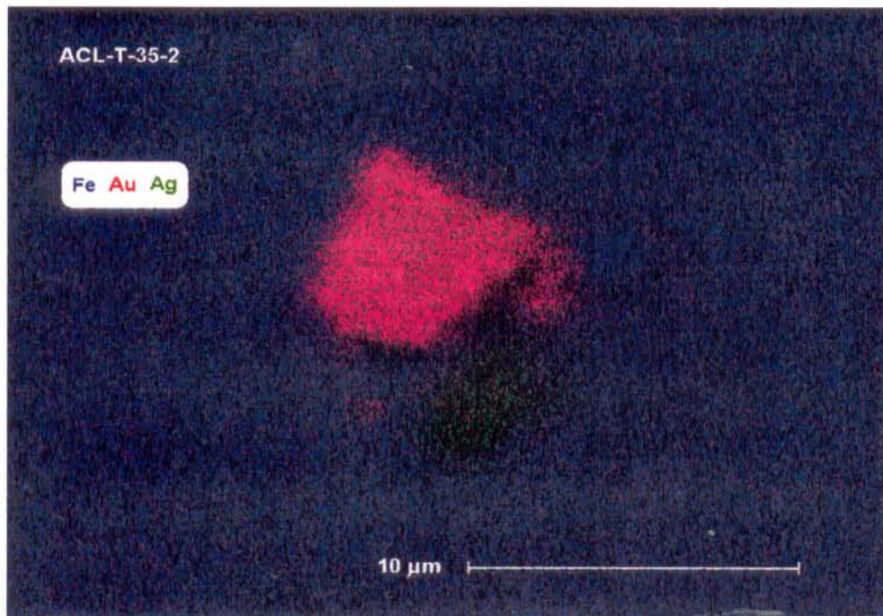
Figura 2.84 - Imagens do mapeamento geoquímico do Au (vermelho), da Ag (verde) e Fe (azul) com o MEV-EDS, em grão de ouro associado aos gossans, da TR-35, na área Águas Claras. O grão inferior, apesar da coloração verde é cassiterita.
