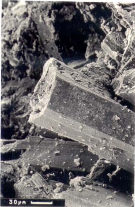
Figura 2.41 - Início da destruição dos cristais de dravita ao longo do F-44, Águas Claras (MEV).
