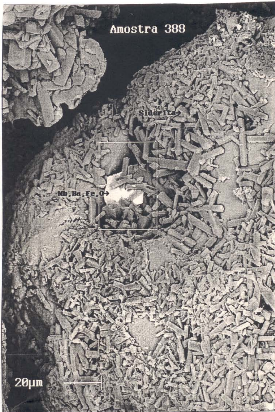
Figura 68 - Cristal de bariopirocloro envolvido por cristais prismáticos de siderita na brecha carbonática (MEV).
