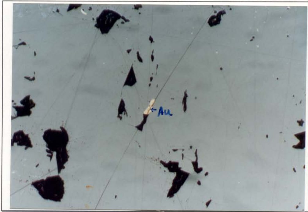
Figura 3.15 Ouro (Au) ocupando plano de clivagem da esfalerita (Esf). (200X). Marmato nível 200-1.
