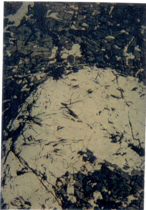
Fig.31c - Bandas de turmalina verde alternada a bandas de quartzo com agulhas de anfibólio. Aumentada 25 vezes; nicóis //.
