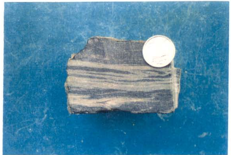
Fig. 9d - Metatufo bandado com CPX. Os aspectos microscópicos serão vistos nas figuras 18b e 18c.
