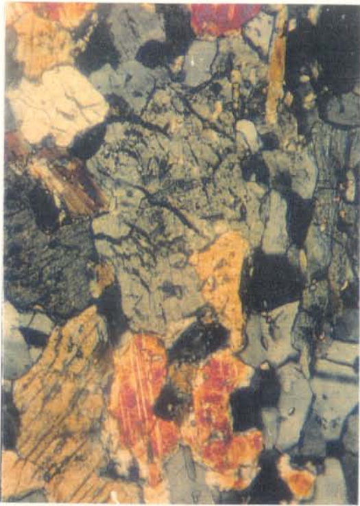
Fig. 19a - Fenoblasto de diopsídio substituído por epidoto (amarelo) e actinolita (maclado). Aumentado 100 vezes; nicóis X.
