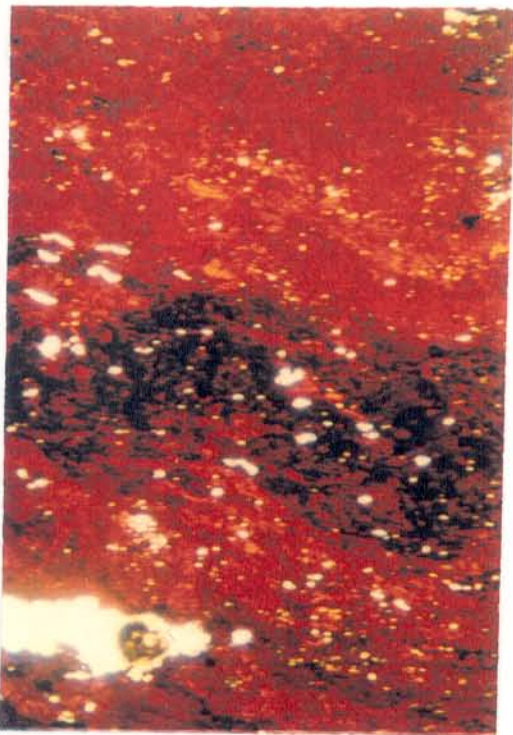
Fig. 31a - Plasma hematítico-goethítico desenvolvido sobre anfibólito, com preservação da foliação original. Aumentada 10 vezes; nicóis //
