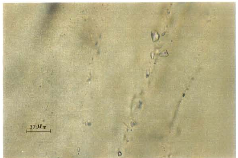
Fig. 71b - Inclusões aquosas tipo 9a, alinhadas segundo planos de fraturas cicatrizadas.
