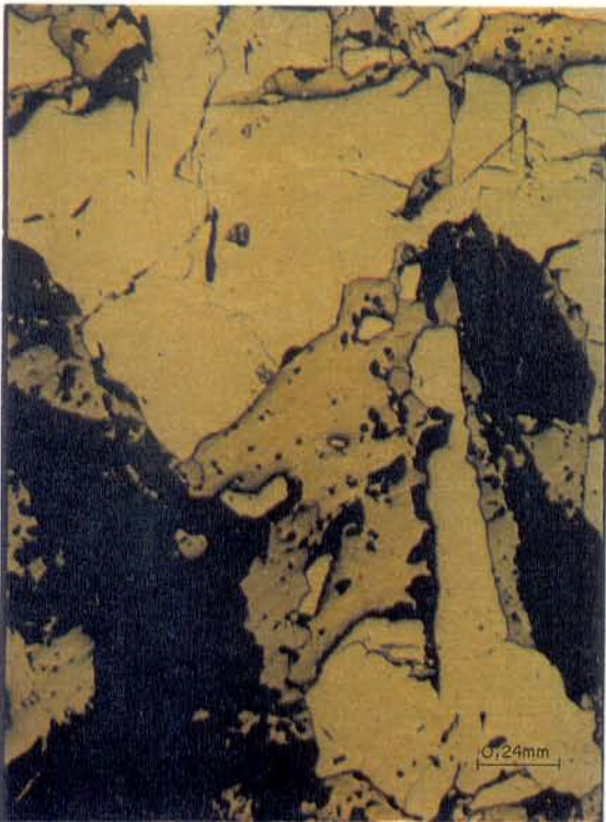
Fig. 34c - Fenoblasto deformado de pirita preenchido por calcopirita intercrescida com pirrotita. Aumentada 40 vezes; nicóis //.
