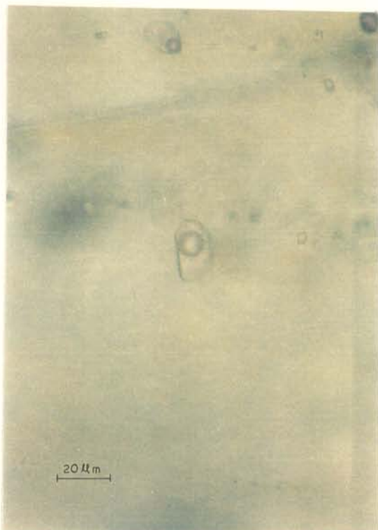
Fig. 61a - Detalhe de inclusões áquo-carbônicas (tipo 2), constituídas por uma fase líquida aquosa, mais clara e outra líquida de CH 4 , N 2 , (H 2 S), mais escura.
