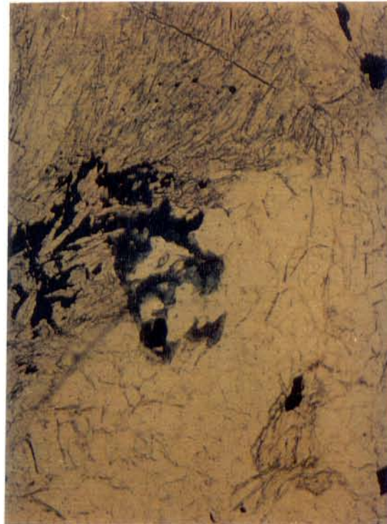
Fig. 23d - Fenoblasto de turmalina corroído por cordierita e quartzo em contato com antofilita contendo opacos segregados. Aumentada 25 vezes; nicóis //
