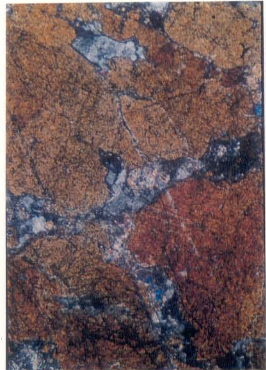
Fig. 19d - Fenoblastos maclados e fraturados de CPX, com as fraturas e os espaços intersticiais preenchidos por microclina e carbonato. Aumentada 25 vezes; nicóis X.
