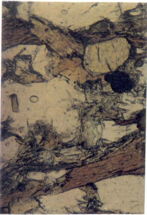
Fig. 30a - Cristais euédricos de turmalina verde, inclusos em biotita e em cordierita associadas a andaluzita fibrosa. Aumentada 100 vezes; nicóis //
