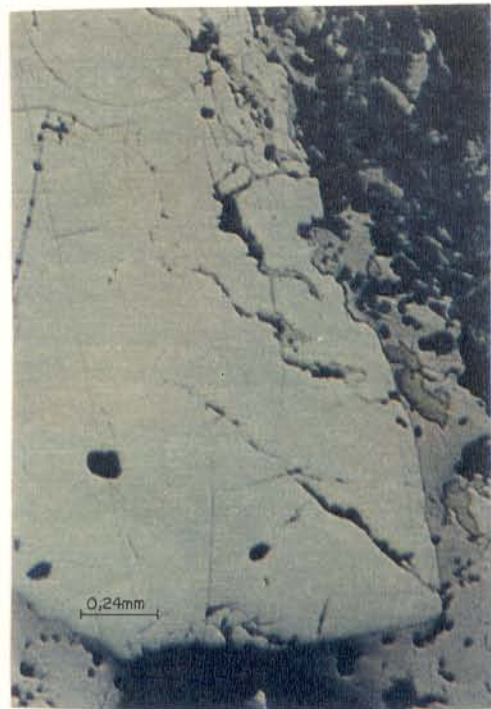
Fig. 34b - Fenoblasto subidioblástico fraturado de pirita em contato e parcialmente preenchido por pirrotita, intercrescida com calcopirita. Aumentada 40 vezes; nicóis //.
