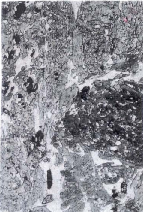
Fig. 9c - Hornfels com textura poiquiloblástica tipo peneira , em que fenoblastos de hornblenda são diversos em uma matriz fina quartzo - feldspática. Aumentada 25 vezes; nicóis //.
