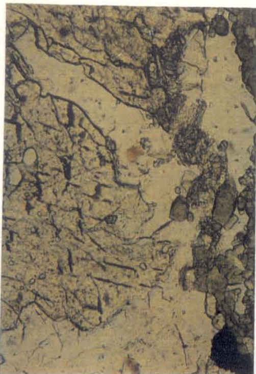
Fig. 29a - Agregados euédricos de turmalina associados a fenoblastos xenoblásticos de andaluzita. Aumentada 100 vezes; nicóis //
