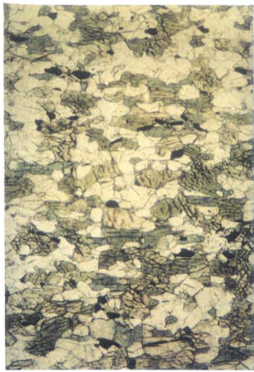
Fig. 9b - Hornblenda (verde) e grunerita (incolor), misturadas às porções granoblásticas quartzo-feldspáticas e opacos, configurando uma textura grano-nematoblástica. Aumentada 25 vezes; nicóis //.
