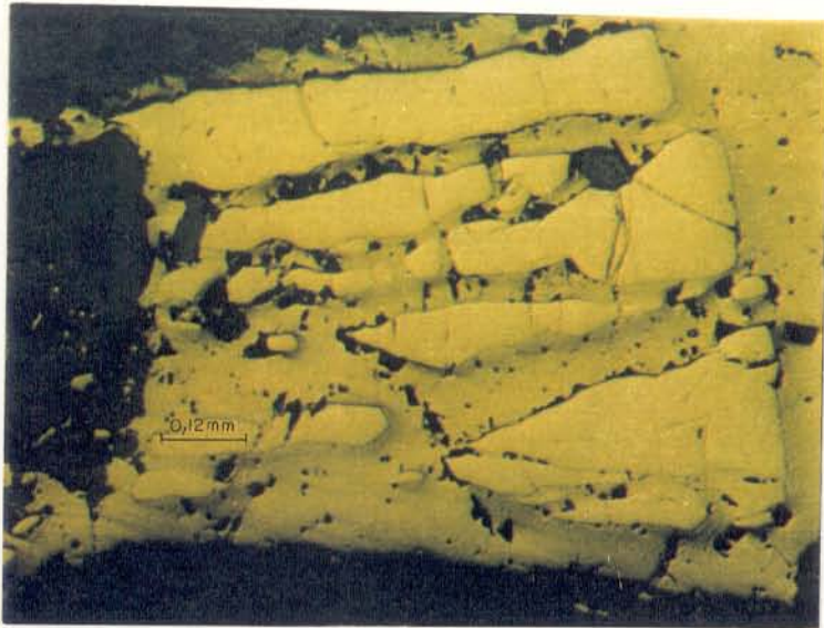
Fig. 35a - Fenoblasto de pirita sendo substituído por pirrotita, formando bandas descontínuas paralelas à foliação. Aumentada 40 vezes; nicóis//.
