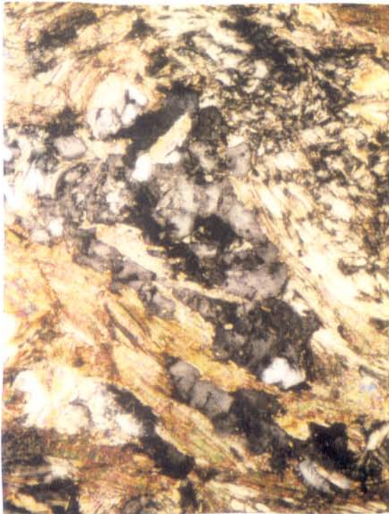
Fig. 20c - Cristais de antofilita em contato com biotita e plagioclásio em rocha a quartzo-clorita. Aumentada 25 vezes; nicóis X.
