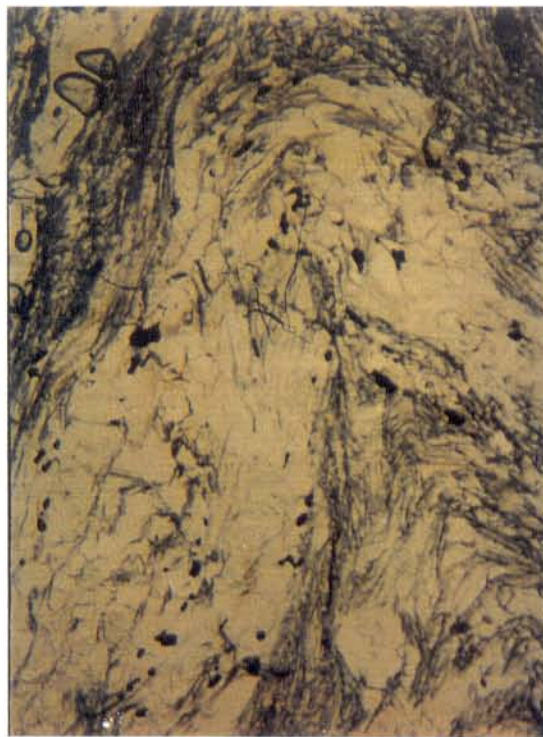
Fig. 23b - Bandas dobradas de cordierita e antofilita com inclusões de rutilo. Aumentada 10 vezes; nicóis //
