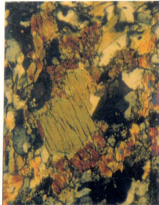
Fig. 18d - Fenoblasto de hornblenda verde substituída por epidoto incolor, com segregação de opacos. Aumentada 100 vezes; nicóis X.
