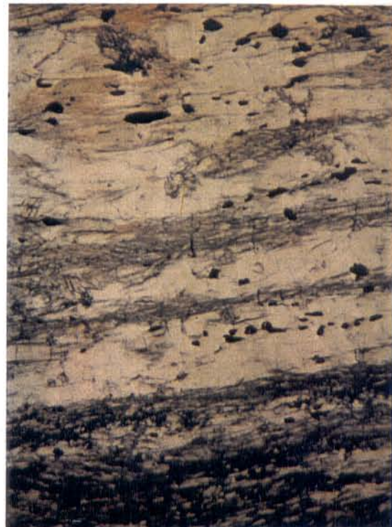
Fig. 20d - Textura anisotrópica com intercalações de bandas de cordierita e antofilita e pequenos cristais de rutilo. Aumentada 10 vezes; nicóis //.
