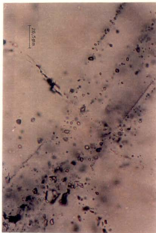
Fig. 61d - Inclusões de CO 2 (tipo 6) alinhadas segundo planos de fraturas.
