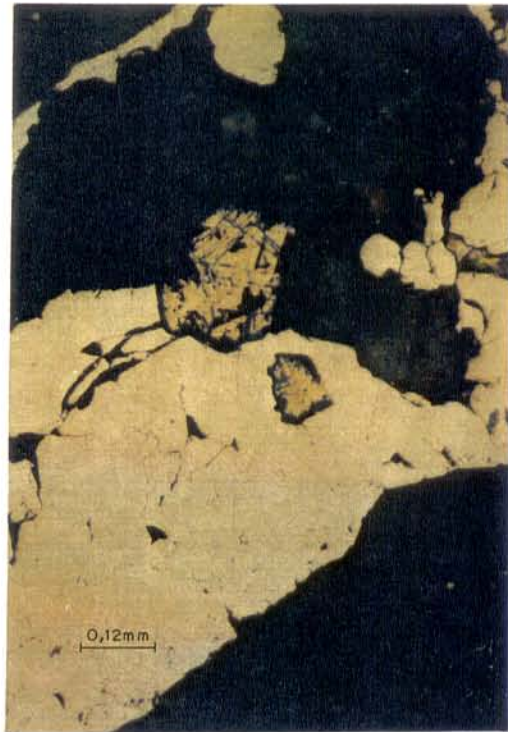
Fig. 50b - Pirita intercrescida com calcopirita com lamelas de covelita, infiltrada em quartzo de BIF tipo silicato cisalhada. Aumentada 80 vezes, nicóis //.
