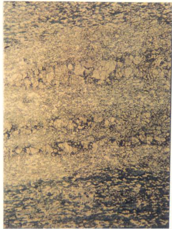
Fig. 18b - Metavulcânica bandada, em que bandas granoblásticas claras diopsídio, andesina/labradorita e epidoto de 0,25 a 0,62mm são alternadas às bandas verde-escuras nematoblásticas, compostas de hornblenda e andesina/labradorita de 1,5 e 4,5 mm. Aumentada 10 vezes; nicóis //.
