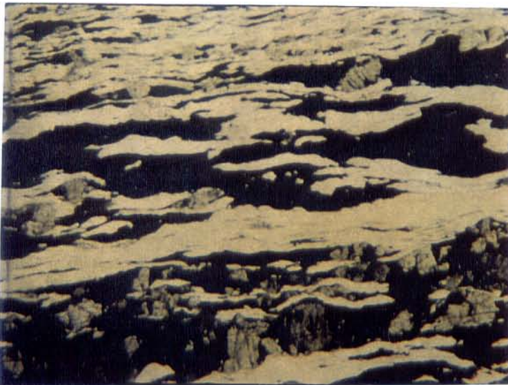
Fig. 24c - Textura anisotrópica bandada de BIF tipo óxido, com bandas de quartzo (brancas), alternadas a bandas de opacos e actinolita. Aumentada 10 vezes; nicóis //
