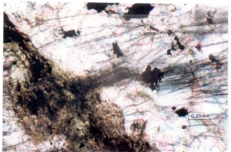
Fig. 55d - Planos de indusões de metano em quartzo, ligando cristais de calcopirita (pretos) a bandas de clorita.
