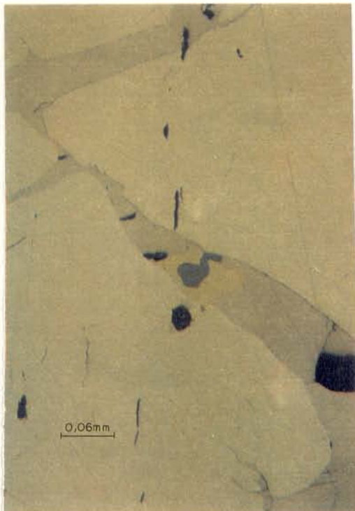
Fig. 35c - Aberturas em fenoblasto altamente fraturado de pirita, preenchidas com matriz de sulfetos dúcteis (pirrotita intercrescida com calcopirita e esfalerita) Aumentada 160 vezes; nicóis //.
