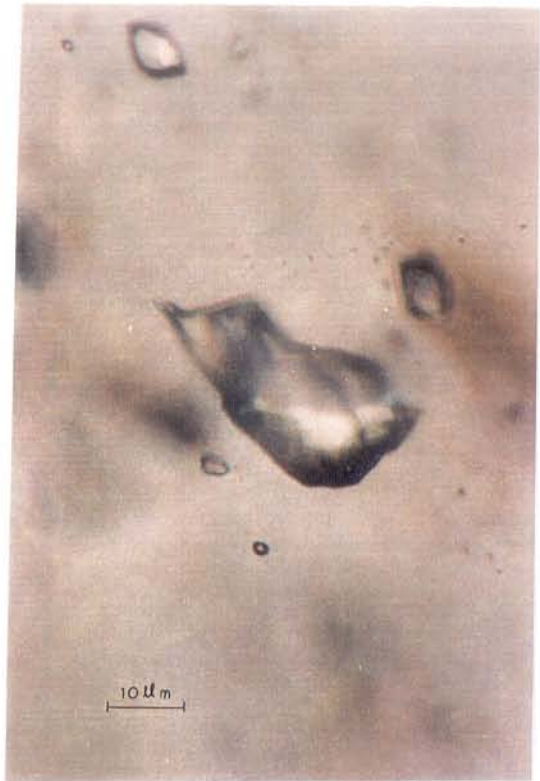
Fig. 55b - Detalhe de indusões de metano da figura anterior.
