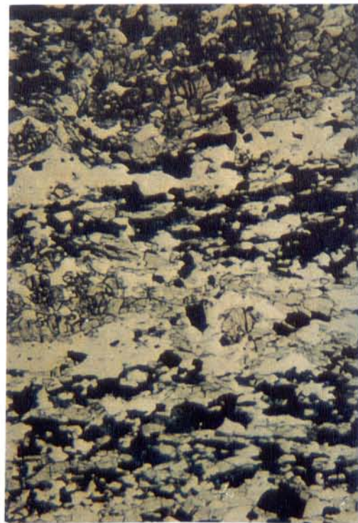
Fig. 24d - Bandas de granada almandínica poiquiloblástica, com inclusões de grunerita e quartzo gótico, em contato com hastingsita (verde escuro) e alternada com bandas quartzosas. Aumentada 10 vezes; nicóis //
