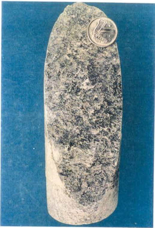
Fig. 20a - Testemunho de sondagem de rocha rica em quartzo-clorita.
