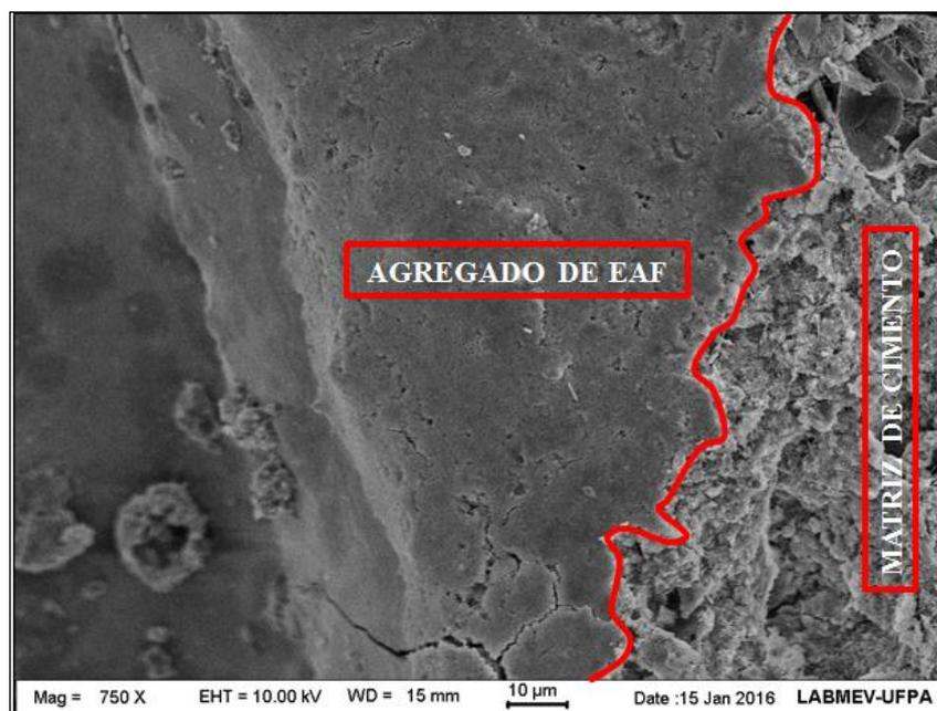
Figura 4.13 - Vista do formato irregular da EAF, melhorando a aderência entre o agregado e a matriz.
