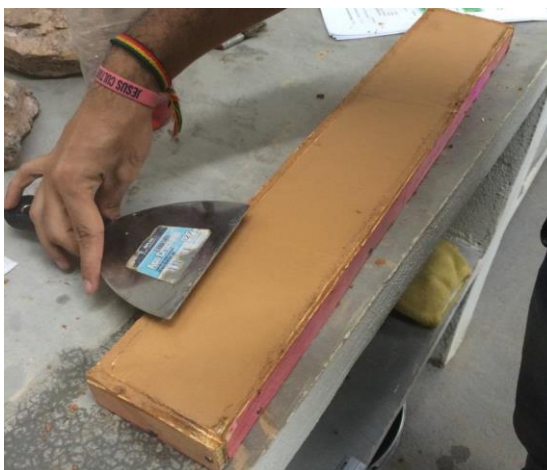
Figura 16 Ensaio de retração linear com o traço que continha 0,1 % de rejeito.
