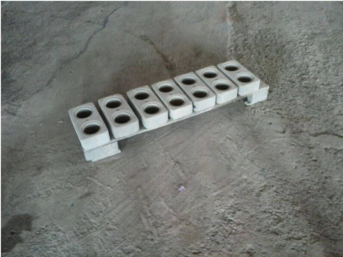
Figura 28 Tijolos solo-cimento com rejeito mineral, após prensagem.
