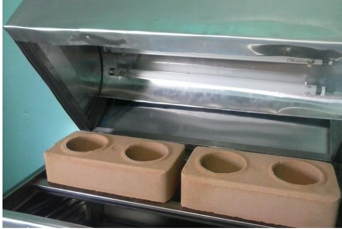
Figura 14 Câmara de envelhecimento acelerado com dois tijolos solo cimento.
