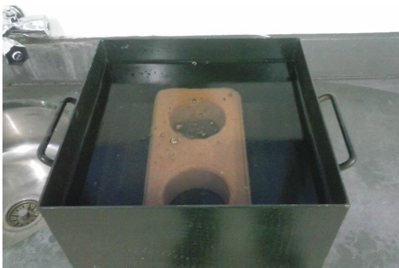
Figura 17 Tijolo solo cimento sem rejeito, note-se a quantidade de ar incorporado que a é liberado ao imergi-lo para o ensaio.
