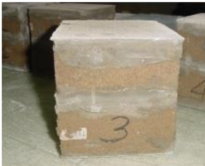
Figura 18 Tijolos solo cimento com rejeito preparados para serem submetidos ao ensaio de compressão.
