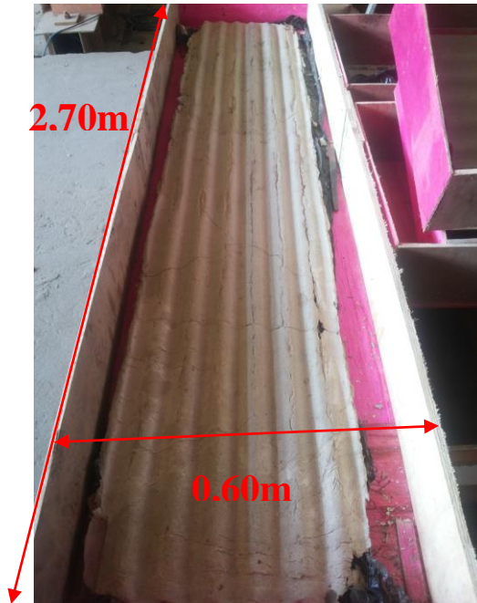
Figura 28 – Telha já moldada em processo de cura. Fonte: Própria autora
