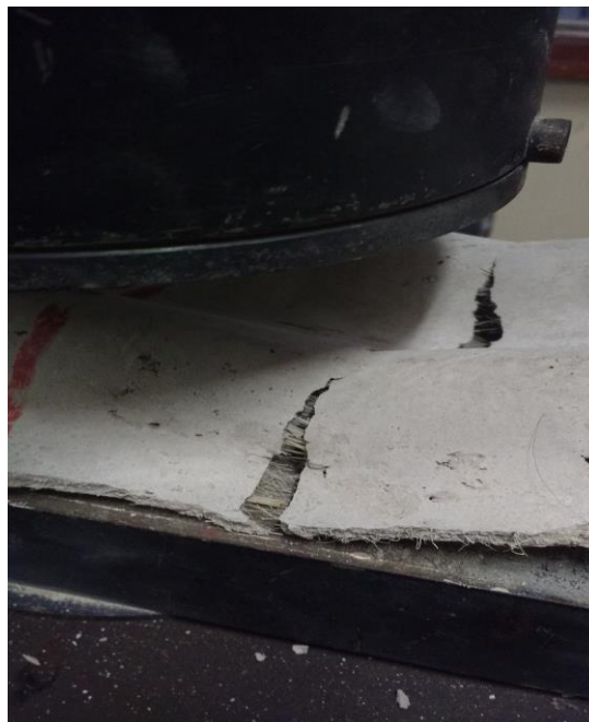
Figura 38 – Ponte fibra-matriz após o ensaio. Fonte: Própria autora.
