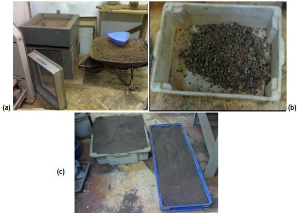
Figura 4.6 - Etapas de beneficiamento. (a) Escória antes do processo. (b) Escória graúda. (c) Escória miúda.
