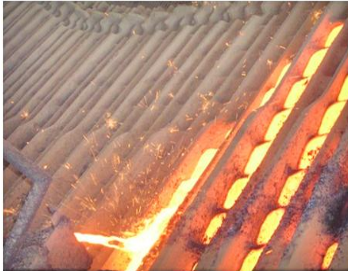
Figura 2.13- Visão parcial da corrida de ferro gusa.
