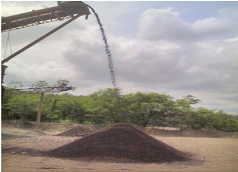
Figura 4.4- Escória sendo britada no pátio da usina-COSIPAR.
