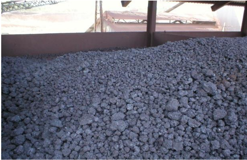
Figura 2.8- Sinter com diâmetro entre 5mm e 50mm.
