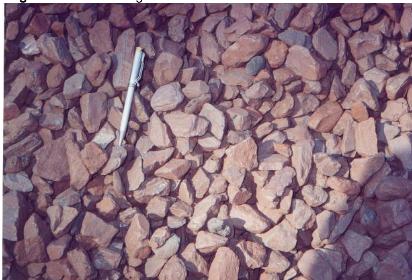
Figura 2.10 – Minério granulado com diâmetro entre 6mm e 40mm.
