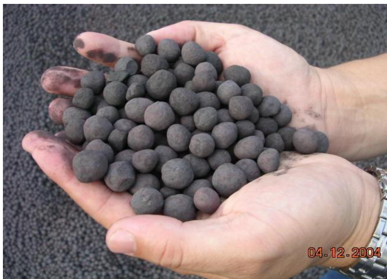
Figura 2.9- Pelotas com diâmetro entre 5mm e 18mm.
