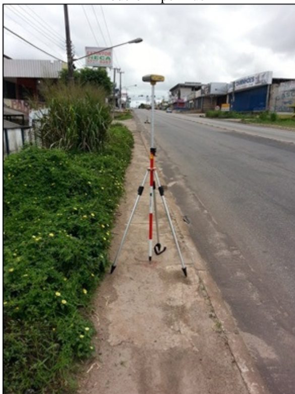
Figura 22 – Ocupação da Estação P-7 com Rastreador de Satélites da Marca Topcon, Modelo HiperPlus
