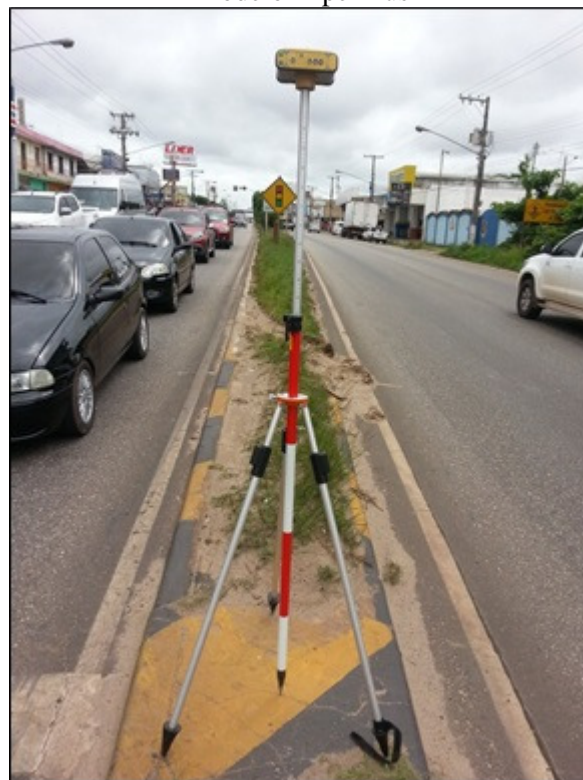
Figura 23 – Ocupação da Estação P-8 com Rastreador de Satélites da Marca Topcon, Modelo HiperPlus
