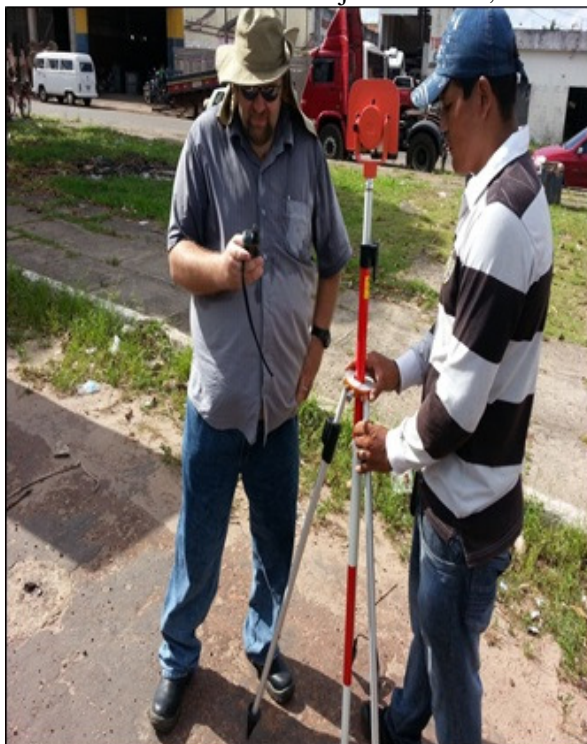
Figura 19 – Prisma, bastão e tripé utilizados no nivelamento com altura ajustada em 1,5 m
