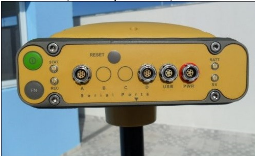
Figura 21 – Receptor de Dupla Frequência (L1/L2) Hiper da Marca Topcon, Utilizado para Determinação das Alturas Elipsoidais
