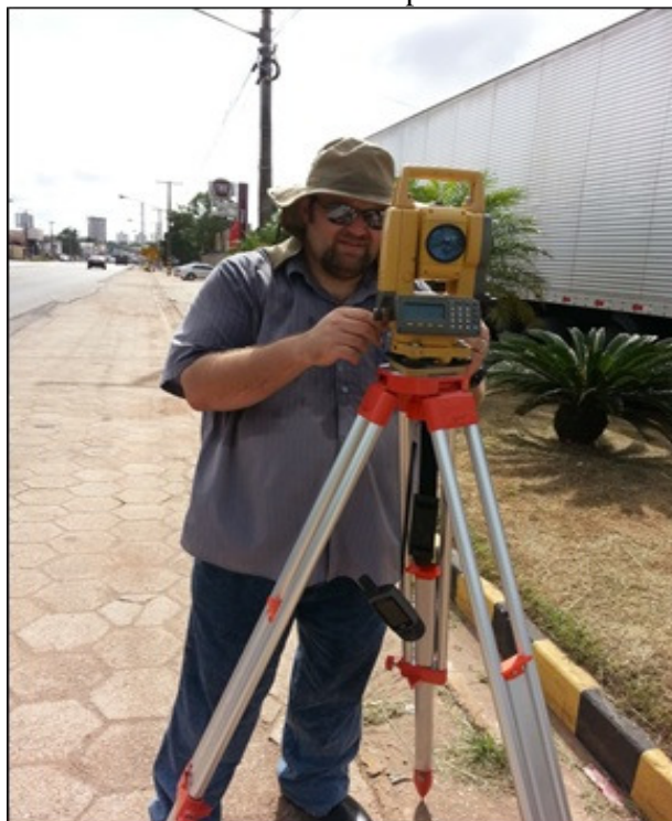
Figura 20 – Estação Total GTS-105N da Topcon estacionada sobre o ponto P-6
