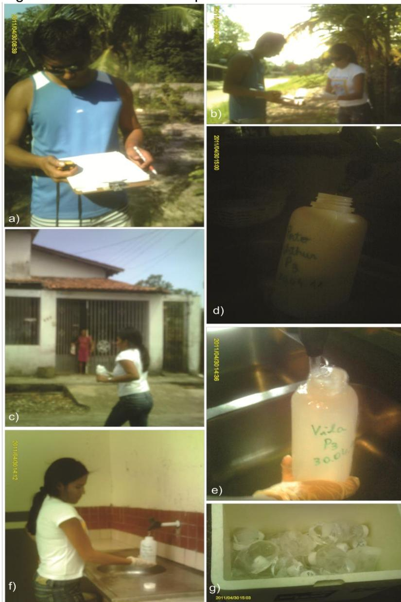
a) Registro das coordenadas dos pontos de amostragem no GPS, b) Preparação para a coleta, c) e d) Coleta em residência no bairro Porto Arthur, e) e f) Coleta em residência no bairro Vila, g) Acondicionamento e preservação das amostras em caixa isotérmica.
