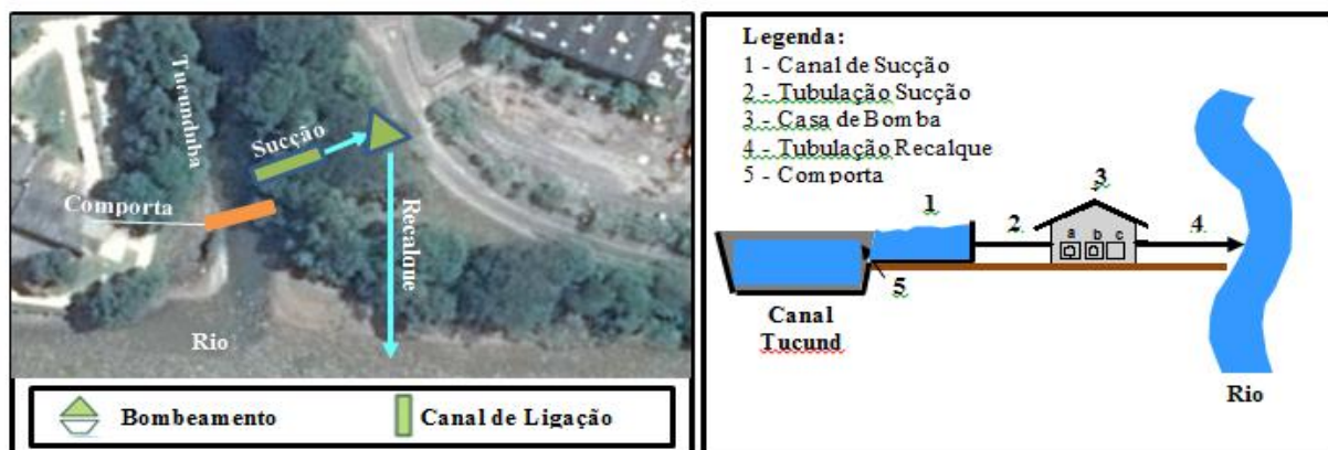
Figura 44- Alternativa Comporta e Bombeamento
