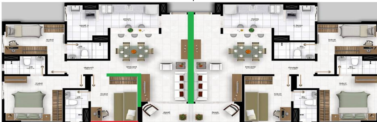
Figura 3.5 - Grupo 1 de vedações verticais internas (verde) e externas (Vermelho) avaliadas nos ensaios em campo.
