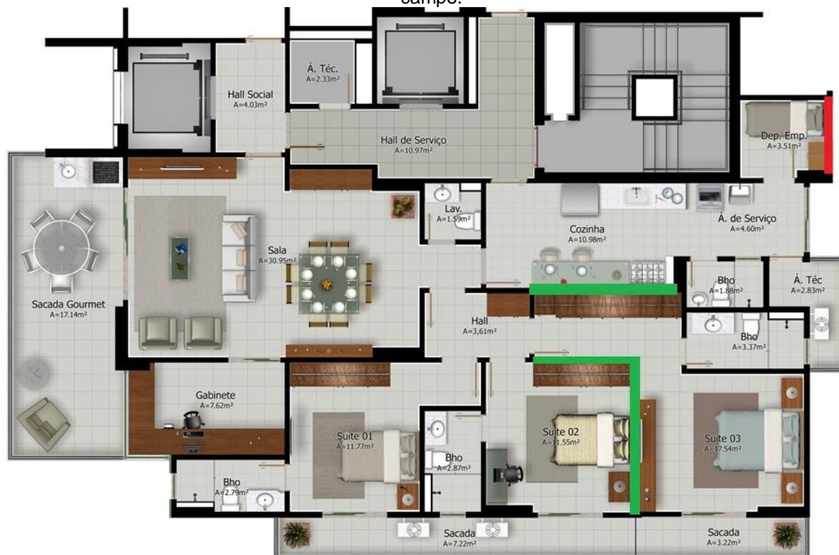
Figura 3.7 - Grupo 3 de vedações verticais internas (verde) e externas (Vermelho) avaliadas nos ensaios em campo.
