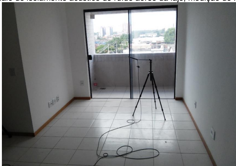
Figura 3.18 - Ensaio de isolamento acústico do ruído aéreo da laje, medição do ruído de recepção.
