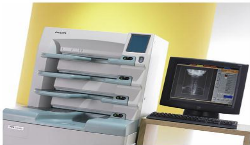
Figura 3: Amostra do conjunto de monitor, acoplado ao aparelho de CR. Fonte: COWEN et al., 2007
